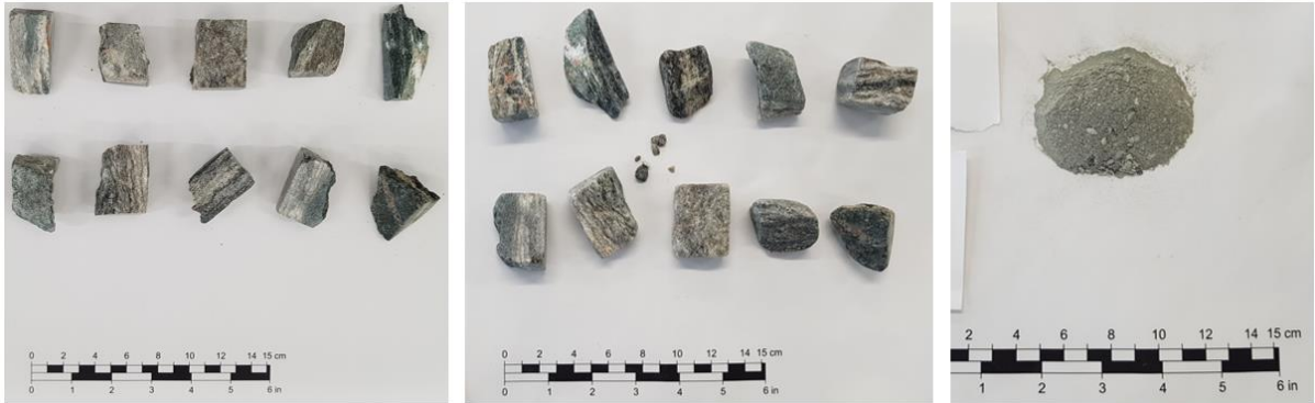
Figur 85 An2.1 før (t.v.) og etter (i midten og t.h.) fire sykluser (SDI 4 = 97,2 %) med slake durability test
