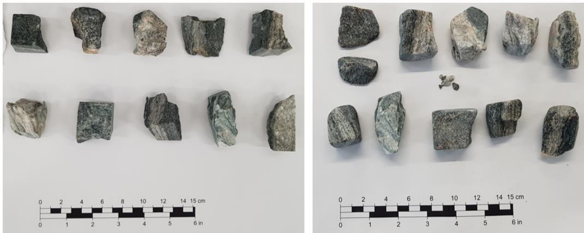
Figur 50 Fotografi av prøvestykkene An.2.2 fra Slake Durability Test før (t.v.) og etter (t.h.) fire sykluser.
