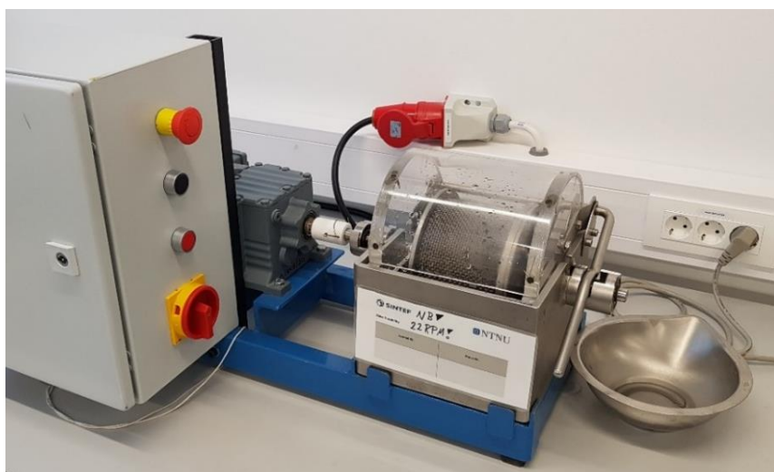
Figur 35 Slake-apparat ved ingeniørgeologisk laboratorium ved NTNU benyttet i Slake-Durability Test. (På bildet ser man en lapp hvor det står «NB! 22 RPM». Dette ble ordnet før testen ble utført slik at omdreiningshastighet var på 20 RPM.)
