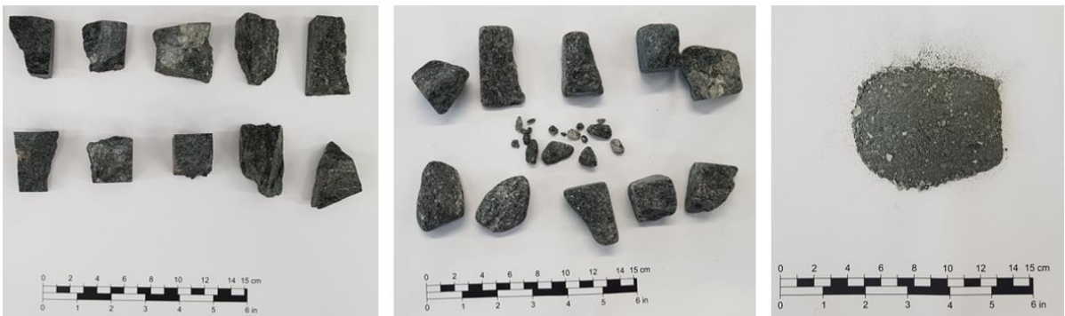
Figur 87 Ga1.1 før (t.v.) og etter (i midten og t.h.) fire sykluser (SDI 4 = 92,2 %) med slake durability test.
