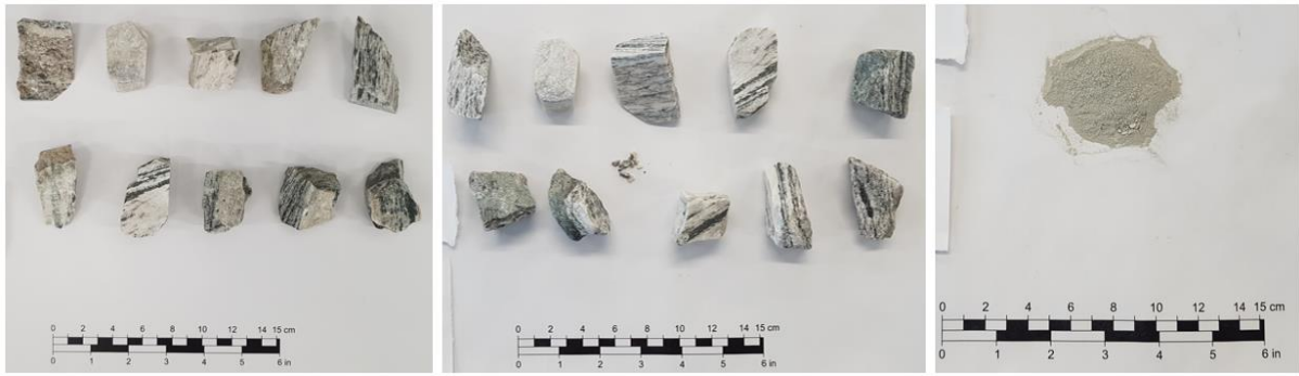
Figur 84 An1.1 før (t.v.) og etter (i midten og t.h.) fire sykluser (SDI 4 = 98,9 %) med slake durability test.
