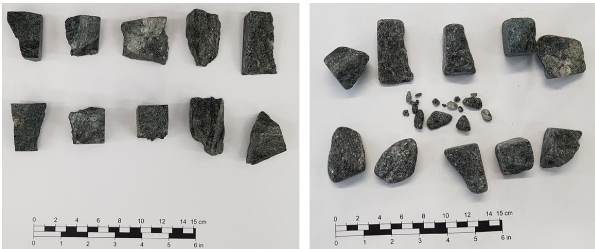
Figur 51 Fotografi av prøvestykkene Ga1.1 fra Slake Durability Test før (t.v.) og etter (t.h.) fire sykluser.
