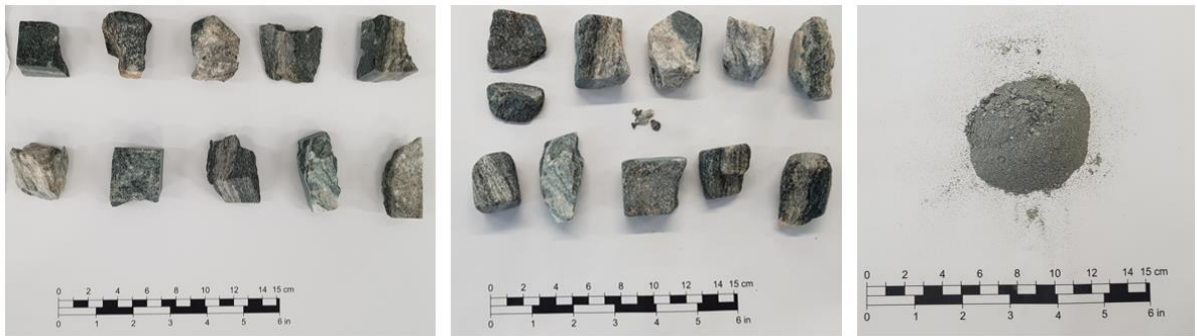
Figur 86 An2.2 før (t.v.) og etter (i midten og t.h.) fire sykluser (SDI 4 = 96,4 %) med slake durability test.
