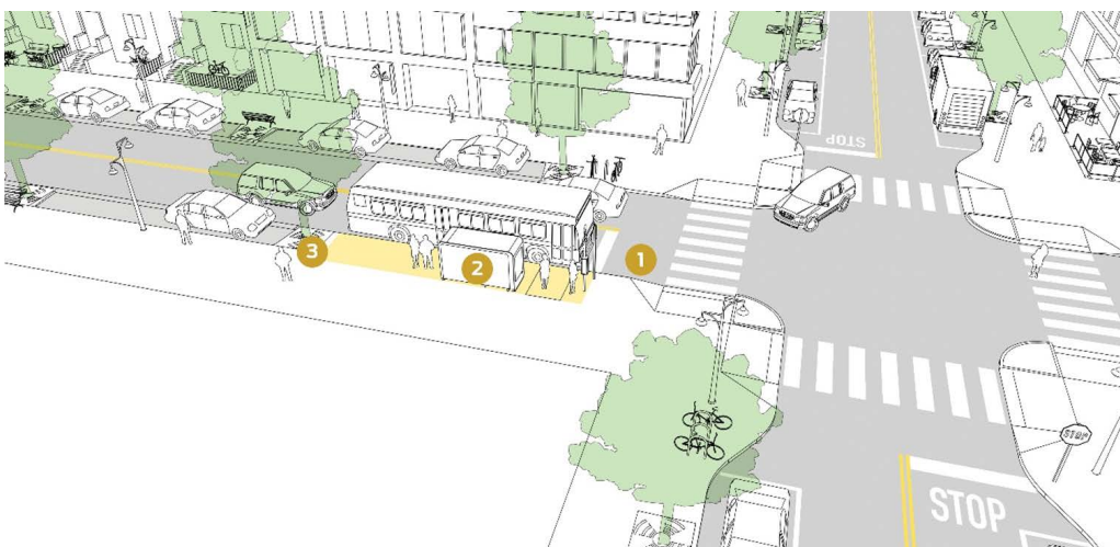
Figur 15 viser kantstopp med utlagt plattform (Officials, 2016).
