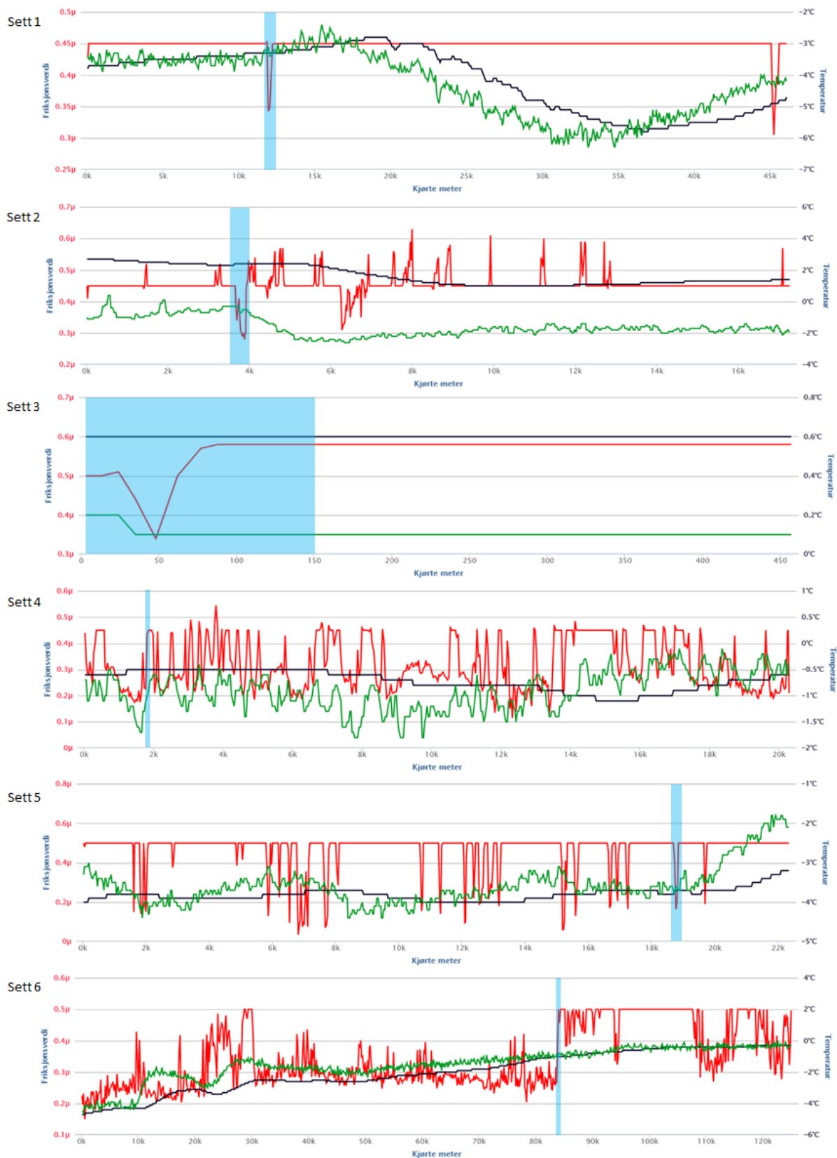
Figur 4.4: Komplette måleserier hentet fra ViaTechs database for hvert av datasettene i Utvalg 2. Andre- lene av måleseriene som utgjør datasettene er markert i blått. De røde linjene viser totalfriksjonsverdiene, de svarte linjene viser lufttemperatur, og de grønne linjene viser vegoverflatetemperatur.
