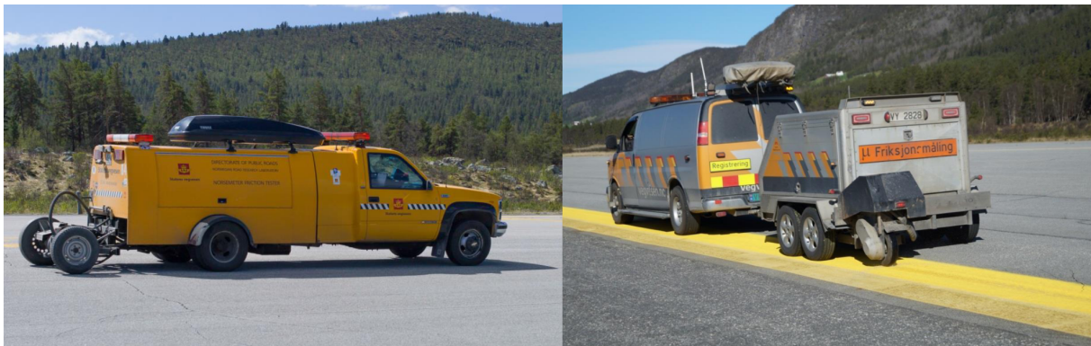
Figur 2.14: Illustrasjon over de kontinuerlige friksjonsmålerne OSCAR (til venstre) og RoAR versjon 5 (til høyre) [24].
