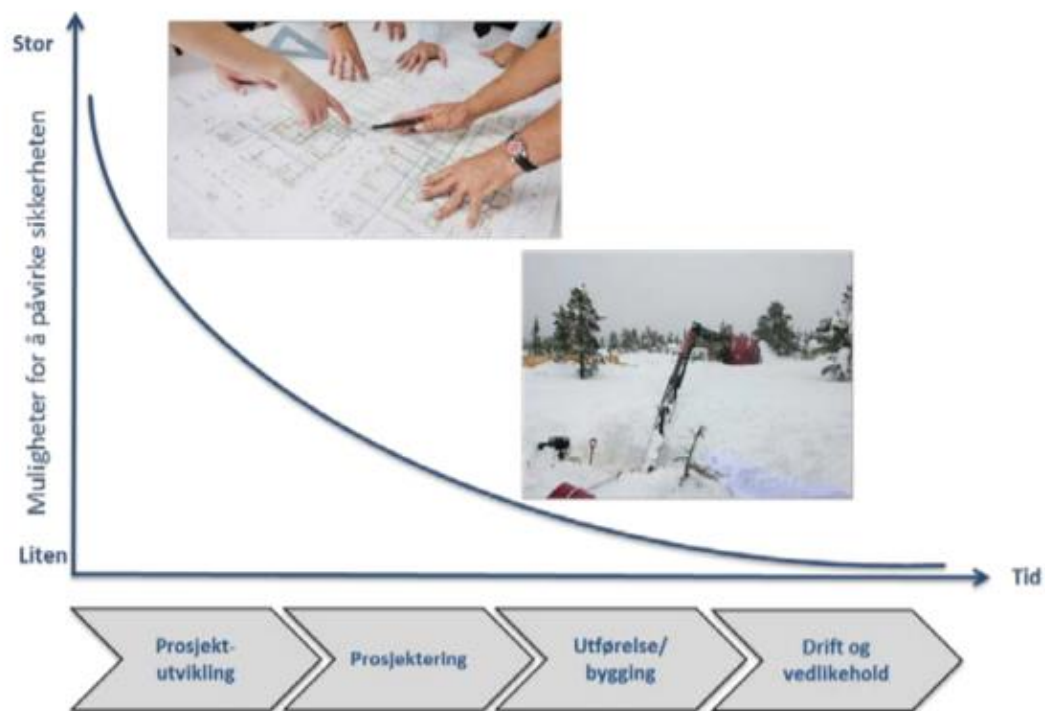
Figur 4 Visualisering av påvirkningsmulighet for sikkerhet i bygg- og anleggsprosjekter over tid (Albrechtsen, Wasilkiewicz, & Tinmannsvik, Styring av Ulykkesrisiko i BA-prosjekter , 2016).
