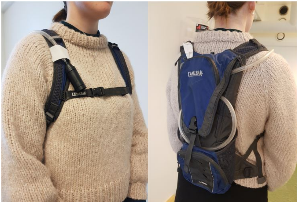
Figur 4.6: Illustrasjon av påmontert personbåren måleutstyr (eget bilde).
