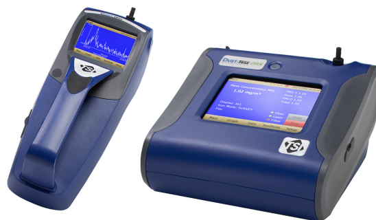
Figur 4.7: Mobilt (t.v.) og stasjonært (t.h.) måleinstrument som ble benyttet (TSI, 2021).
