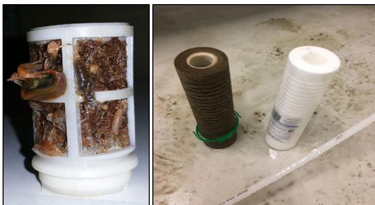
Figur 1: Tett sil på stikkledning hos privat abonnent (t.v.) og tett filter på stikkledning til industriell forbruker (t.h.), foto: Trondheim kommune
