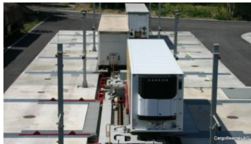
Figur 2.13: Sideveis forskyving av flak fra venteposisjon til tog (Cargo Beamer, ukjent år)
