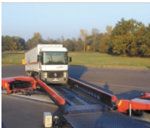
Figur 2.14: Påkjøringsrampe for vogntog. Selve rampen er en fast installasjon (Modalohr, 2003)
