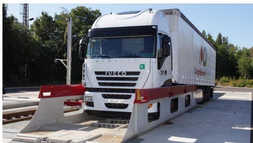
Figur 2.12: Påkjøring på flak som sideforskyves (Cargo Beamer, ukjent år)
