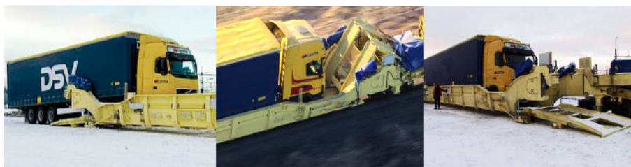
Figur 2.17: Skisse av prinsippet Flexiwaggon (Široký, 2012)
