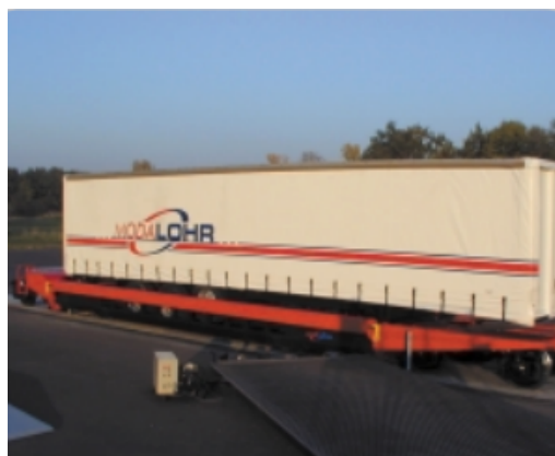
Figur 2.15: Lastbærer i posisjon på togvogn (Modalohr, 2003)
