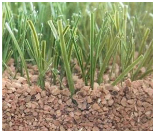
Figur 4: Nærbilde av kork brukt som fyllmateriale på en kunstgressbanene under tørre forhold [5].
