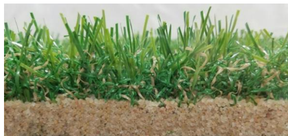
Figur 6: Nærbilde av kunstgressmatte med sand som fyllmateriale [23].
