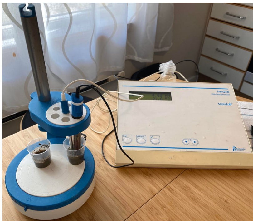
Figur 3.6: Oppsett for pH-måling av prøvene.
