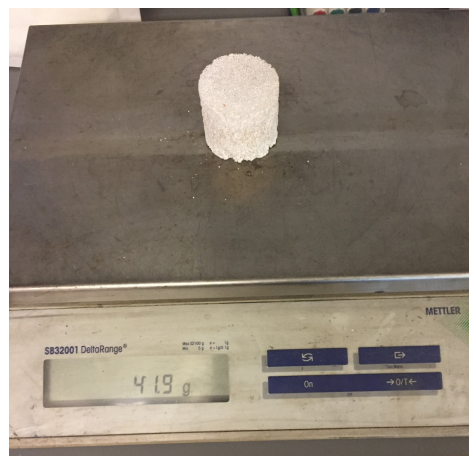
(d) The Mettler Toledo SB32001 Delta Range Balance used.
