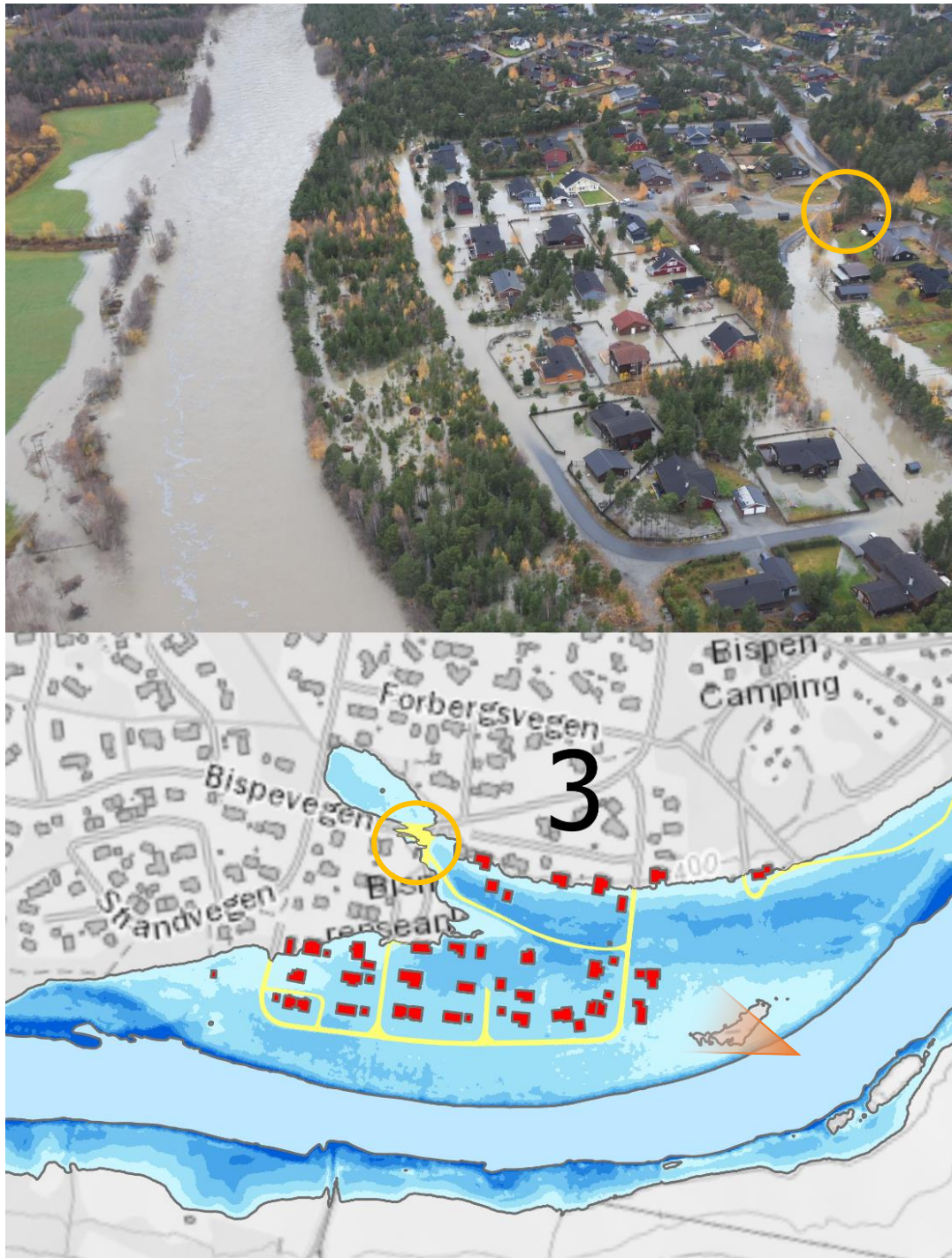
Figur 7.6: Oversvømt areal ved område 3 under oktoberflommen og ved modellert 200-årsflom, område med forskjell i oversvømmelser markert med oransje sirkel. Markert med oransje figur er antatt posisjon av kamera (Rognstrand, Bugge, & NTB, 2018, redigert av forfatter).
