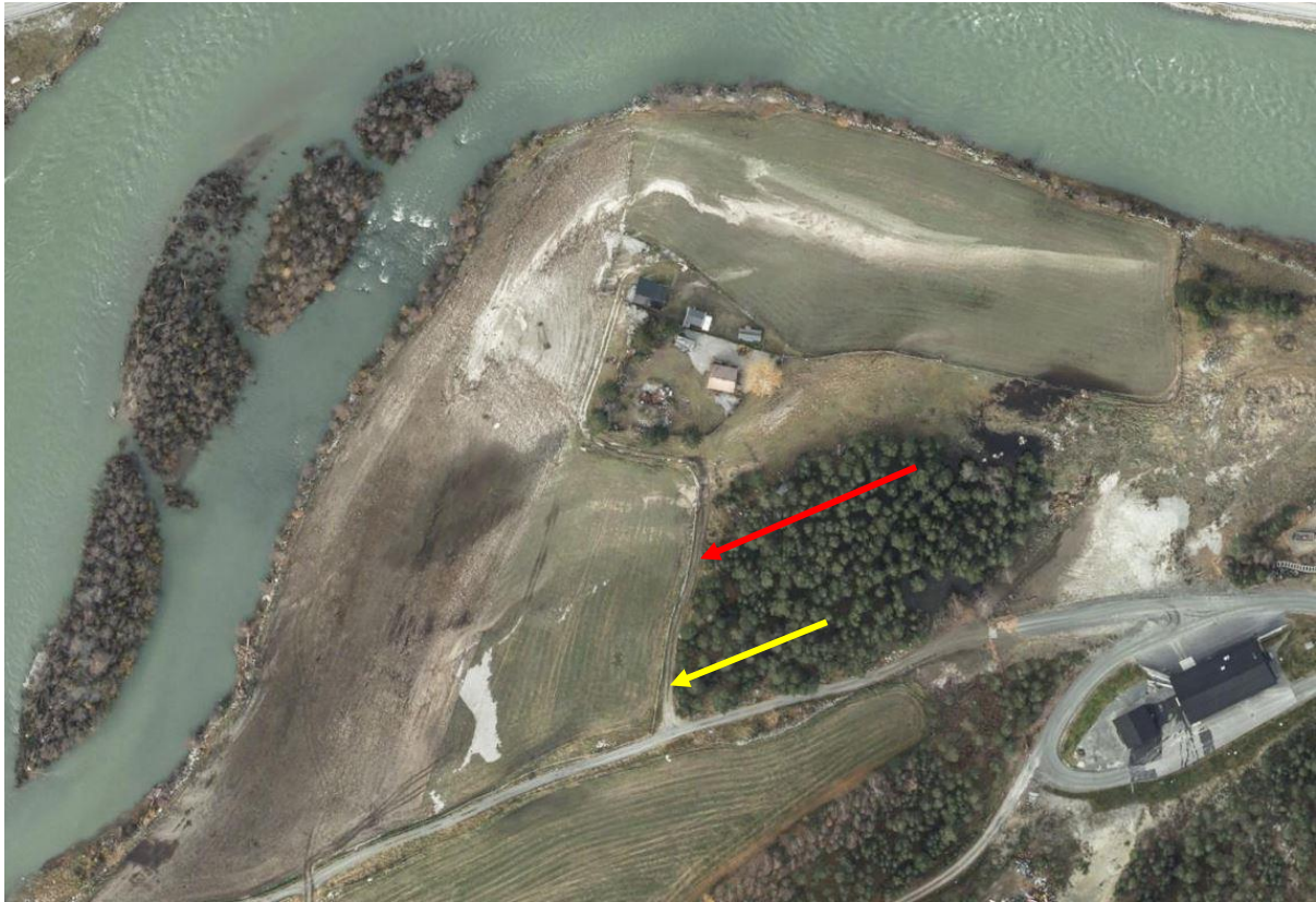
Figur 7.9: Flyfoto fra norgebilder over område 4 med mulig flomgrense under oktoberflommen markert med rød pil, og modellert flomgrense vist med gul pil.
