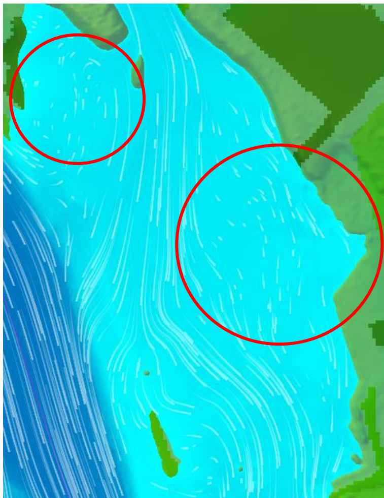
Figur 7.10: Utsnitt av flommodell med partikkelsporing, røde sirkler viser bygningspolygonenes lokasjon hvor partiklenes hastighet senkes.
