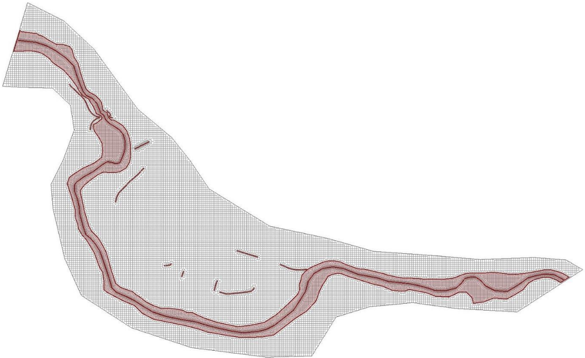
Figur 5.7: Oversikt over hele 2D-cellenettet med bruddlinjer langs elvebanker, elveløpets senterlinje og relevante strømningsbarrierer som veier. Elveløpet er dekt av en refinement region.
