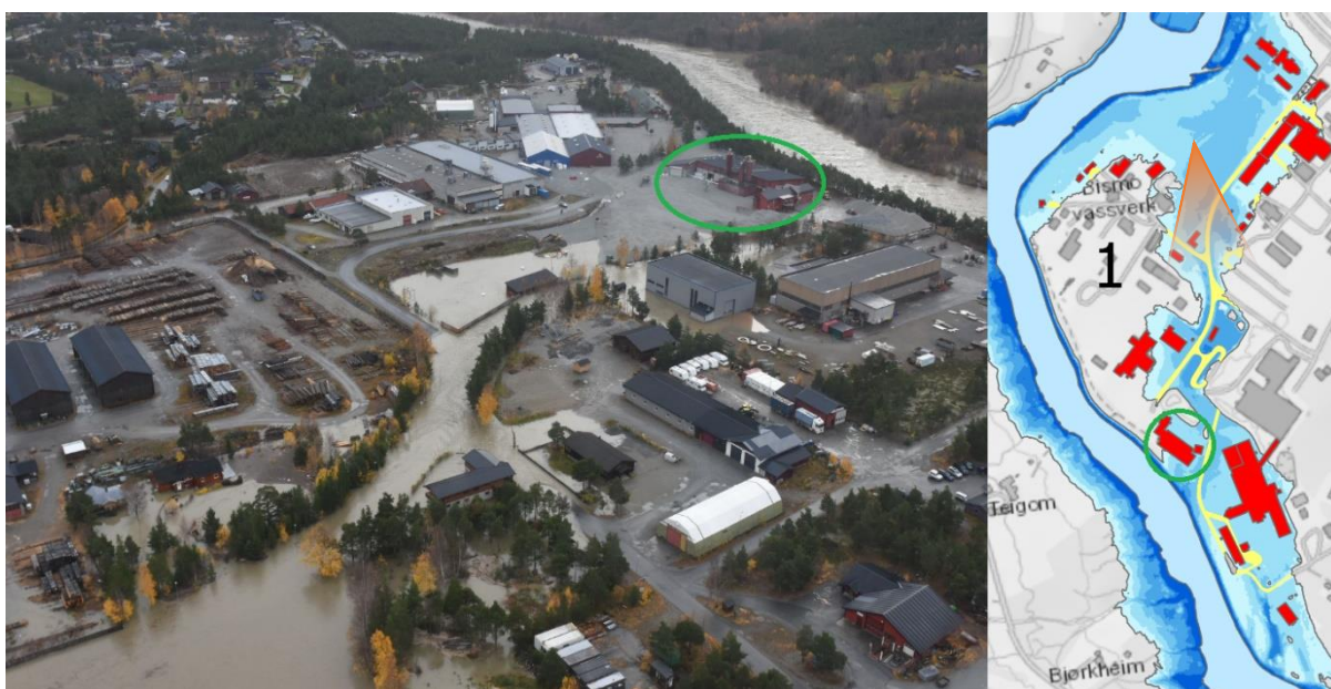
Figur 7.2: Bilde fra oktoberflommen og utsnitt av kartet for en modellert 200-årsflom, med bedriften Glasopor markert med grønn sirkel. Markert med oransje figur er antatt posisjon av kamera (Rognstrand, Bugge, & NTB, 2018, redigert av forfatter)
