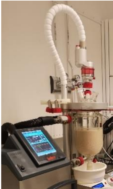
Figur 9 Hydrolyse av restråstoff fra kokt krabbe i reaktor.
