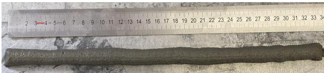
Figur 3.18: Eksempel på en kontinuerlig ekstrudert betong
