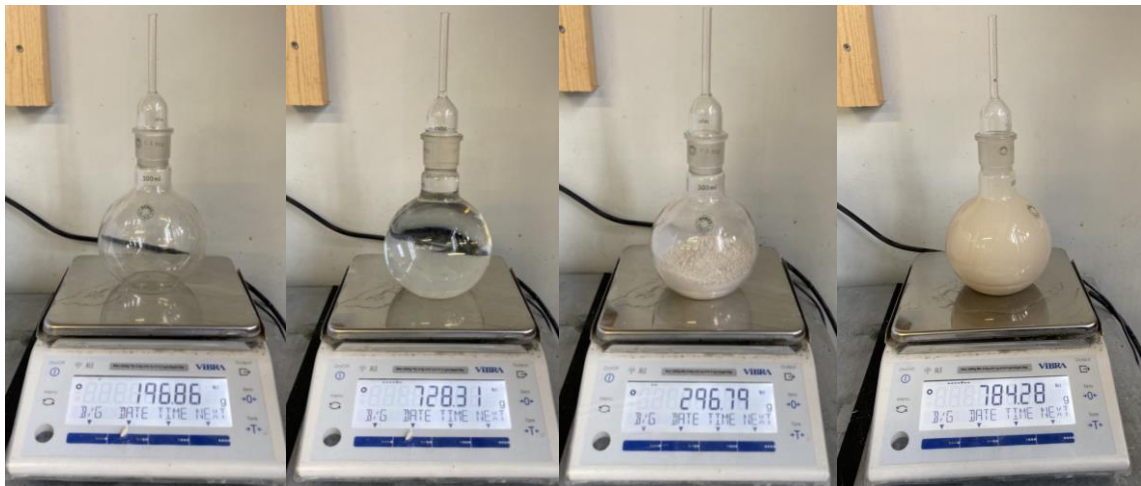
(a) Tom Pyknometer (b) med vann (c) med kalsinert leire (d) med kalsinert leire og vann
