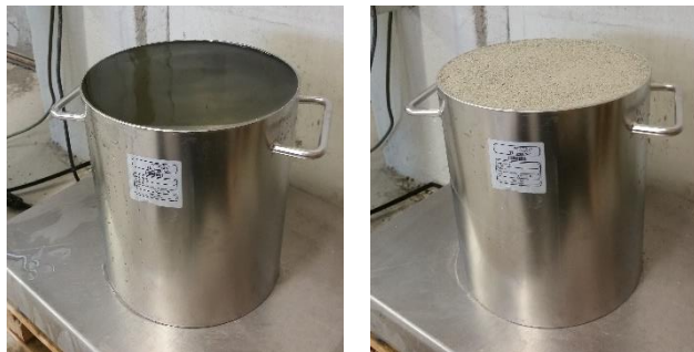
(a) Beholder fylt med vann (b) beholder fylt med tilslag
