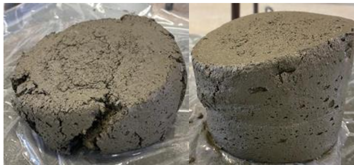
(a) Green strength etter 0 minutter (b) Green strength etter 15 minutter
