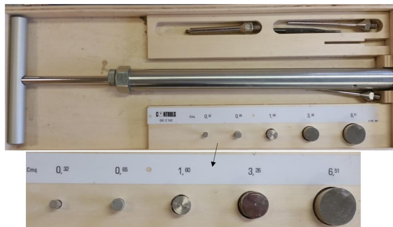
Figur 3.20: Penetrometer med forskjellige nål størrelser.
