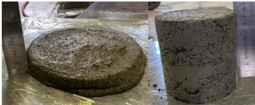
(a) betong med stor høydedeformasjon (b) betong med ingen høydedeformasjon
