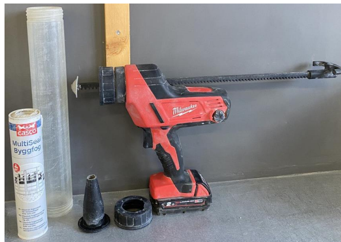
Figur 3.16: Fugepistol brukt for ekstrudering
