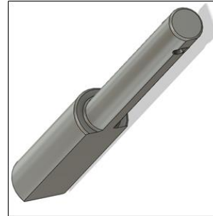
Figur 32: Eksempel på kutt på låsesplint til utløsermekanisme. Laget av Martin Amlie.
