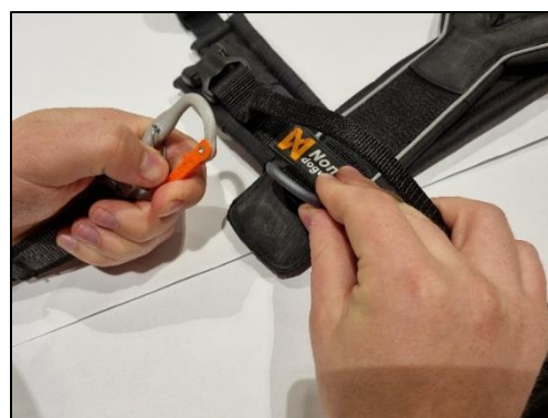
Figur 176: Vaierport på karabinkroken presses ned slik at primærporten ikke står i spenn.
