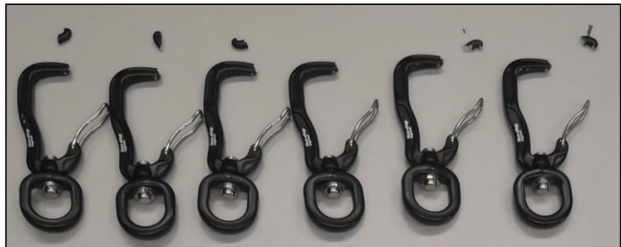
Figur 101: Vaierport etter strekktesting.
