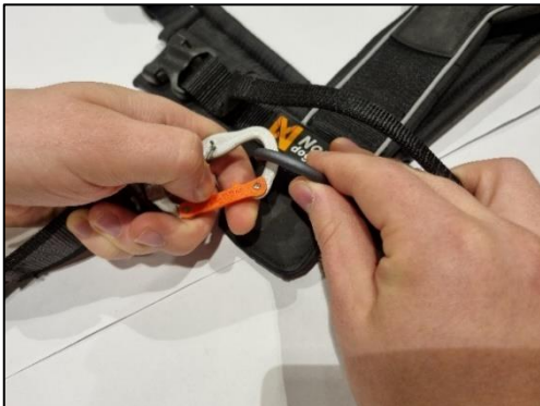
Figur 179: Karabinkroken er festet fast i hundeselen. Vaierporten på karabinkroken bøyes ned slik at primærporten ikke står i spenn.
