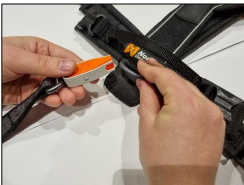
Figur 184: Klypen holdes i en hånd og den andre holder på innfestingspunktet på seletøy: D-ring.
