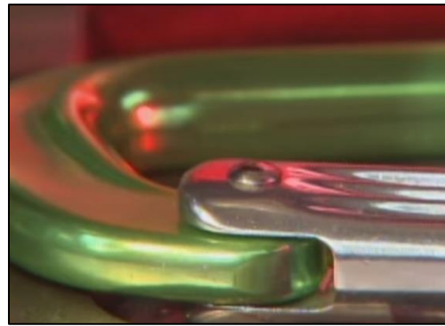
Figur 15: Nagling av port.
