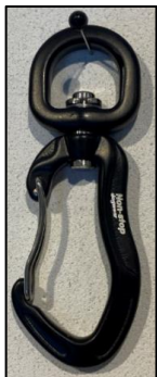
Figur 100: Vaierport før strekktesting.
