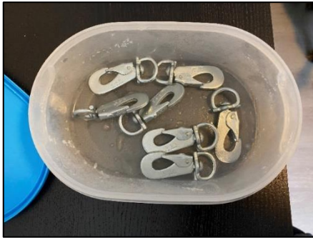
Figur 63: BGB stålkrok i fryst tilstand. Bilde tatt av Lars Erik Vågen.
