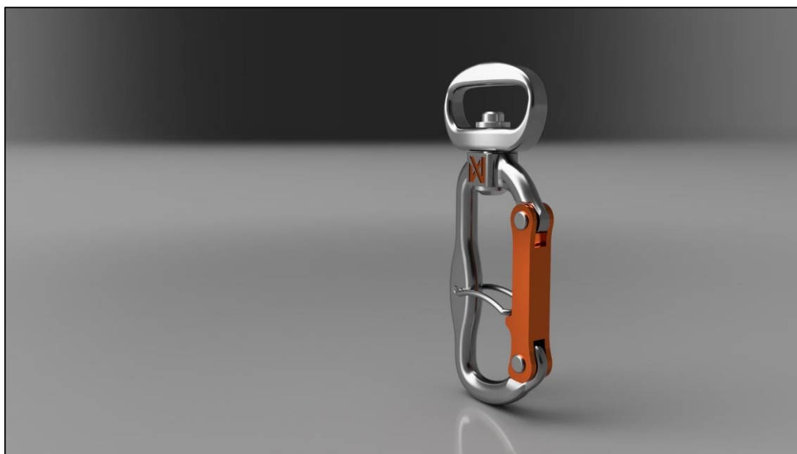
Figur 174: Endelig versjon av Karabinkrok med sekundærlås. Laget av Lars Erik Vågen.
