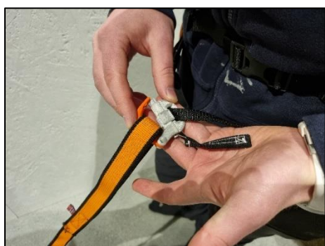
Figur 172: Holder fast i hovedkroppen på utløser og klemmer ned låsebøylen slik at den skal hekte seg på automatisk.
