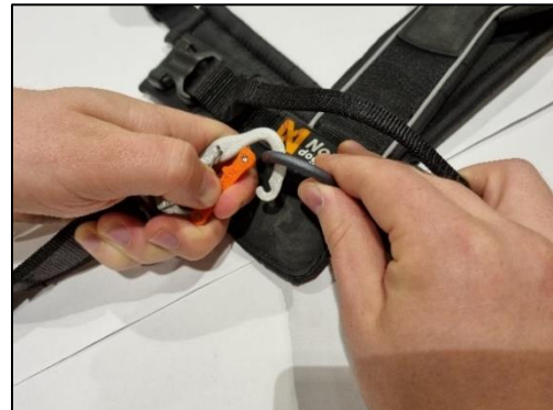
Figur 180: Pekefingeren brukes for å klemme primærporten inn samtidig som man holder vaierporten tilbake. Begynner dermed å dytte den ut fra innfestingspunktet.
