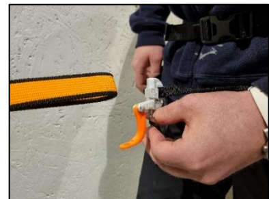
Figur 169: Her har den løst ut og låsebøylen har rotert på grunn av belastningen som går i retningen til båndet. Båndet glir fritt.
