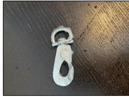
Figur 64: BGB stålkrok i fryst tilstand. Bilde tatt av Lars Erik Vågen.
