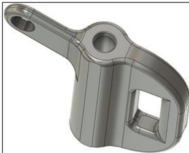
Figur 33: Bilde av kutt under modellene som muliggjør 3D-printing liggende. Laget av Martin Amlie.
