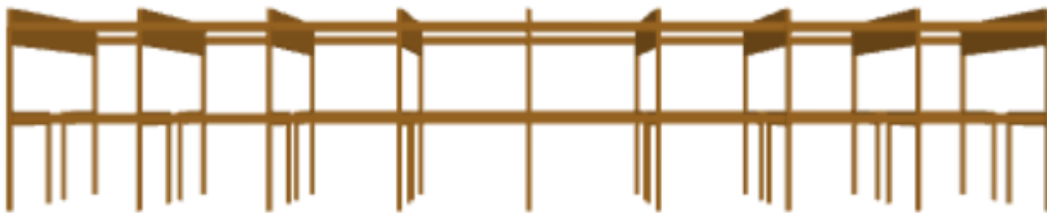
Figur 22 Limtrekonstruksjon. Langside fasadevegg. (Fokus konstruksjon)
