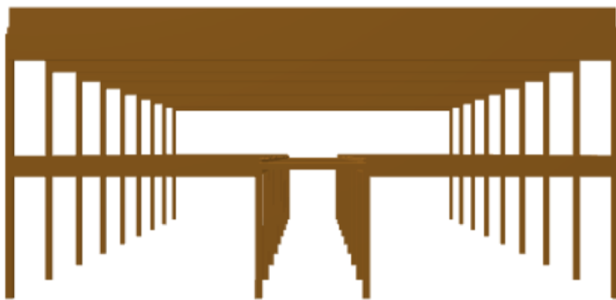
Figur 9 Bildet viser ønsket råbygg i limtre. Bildet tatt fra gavlvegg. (Fokus konstruksjon)
