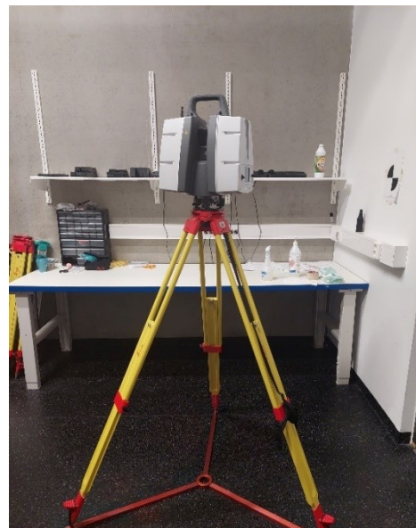
Figur 2 - Leica ScanStation P40, montert på stativ.
