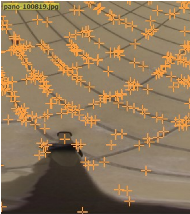
Figur 13 - Visuell kontroll fra Pix4Dmapper viser ATP'er på stativfot og i veldig forvrengte deler av bildet.
