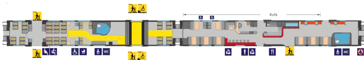
Figur 89. Bilde av utformings-konsept med Kafevogn (Eget bilde, 2021)
