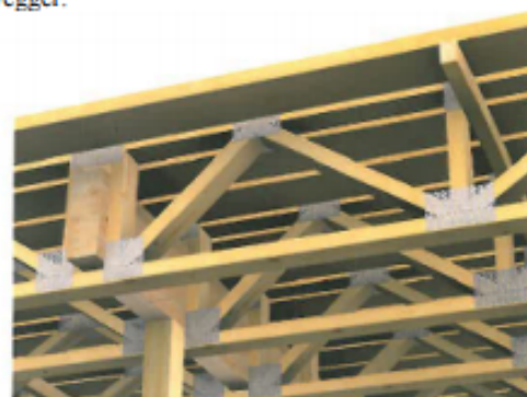
Fig. 6. Gitterbjelkelag med tverrgående bærebjelke understøttet av søyle
