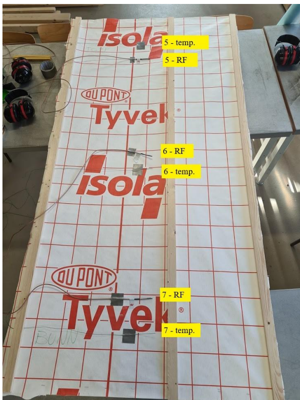
Figur 11: Målere på vindsperren, original vegg (Hanne Bråtømyr, 2021)
