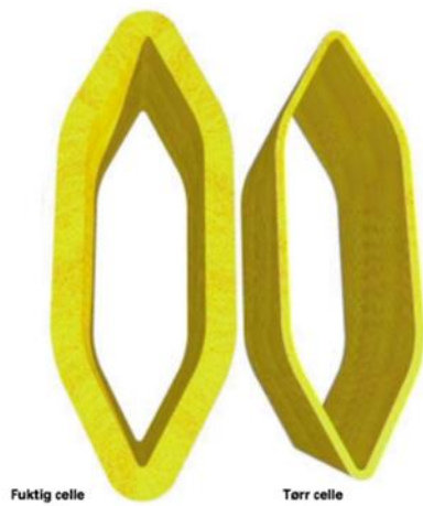
Figur 7: Celleveggykkelse i fuktig og tørt virke (Skaug, 2007)
