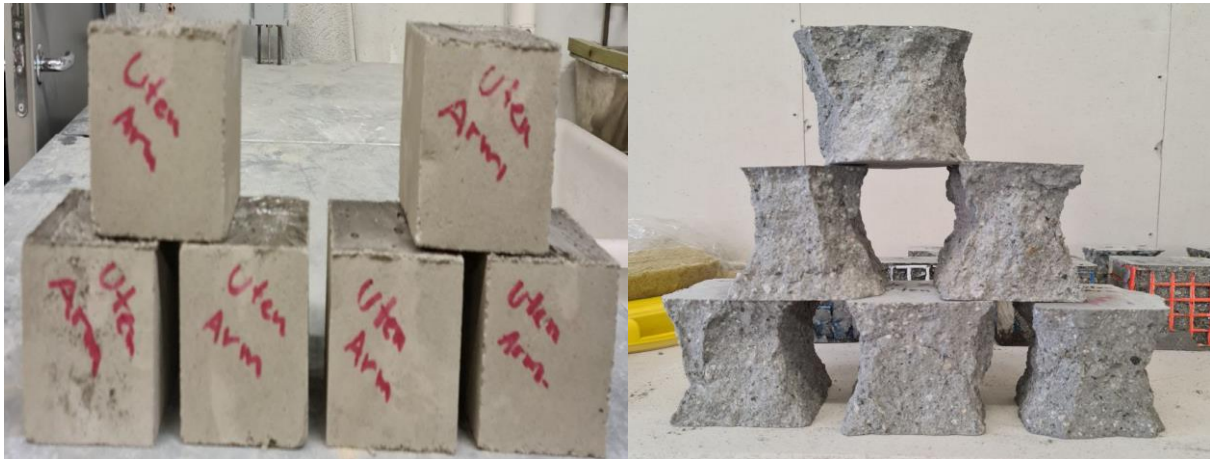
Figur 18 Kuber uten forsterkning før og etter test
