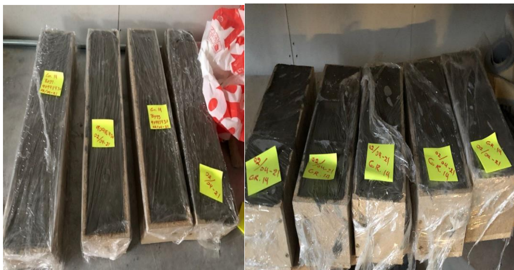
Figur 15 Ferdigstøpet betong i forskallingsbokser
