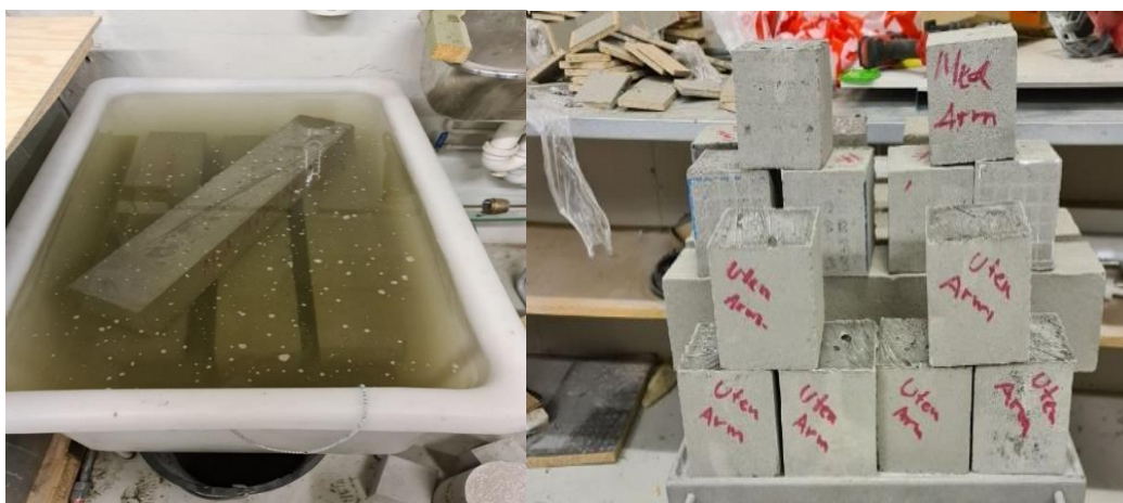
Figur 16 Betong i romtemperert vann i 28 dager
