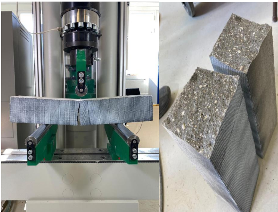
Figur 23 Bøyetest av bjelke uten armering
