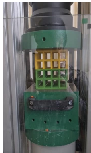
Figur 17 Trykktest av 3D-printet forsterkning utføres
