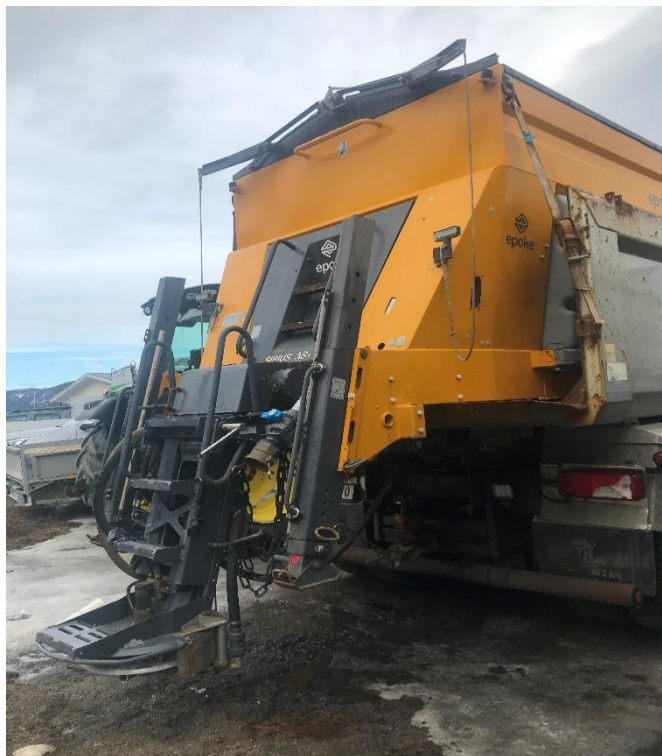
Figur 2-2 Lastebil med utstyr for strøing med befuktet salt (Andreas Skartum)
