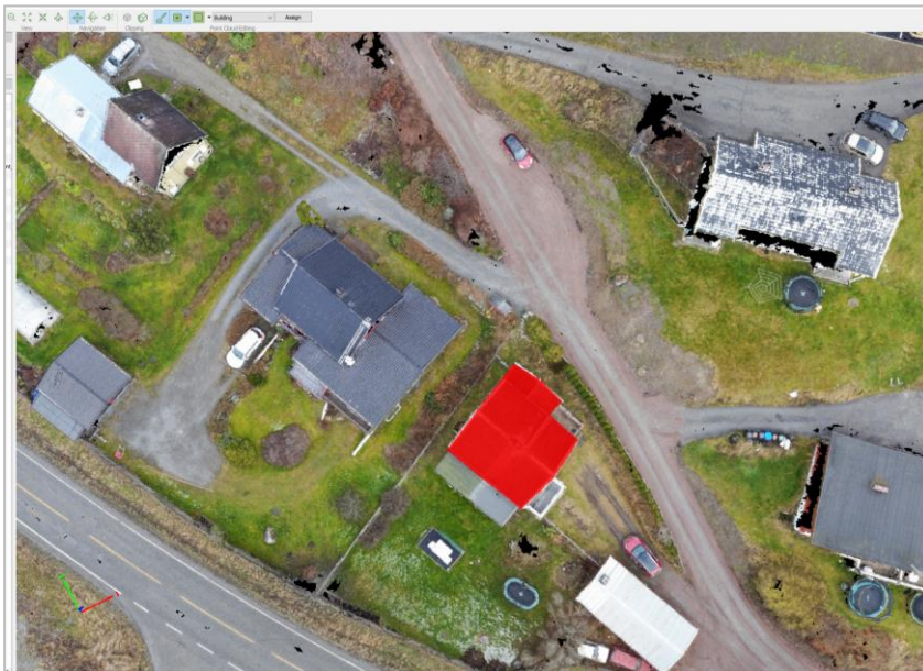
Figur 13. Manuell klassifisering i punkttsky. Punktene av et hustak er markert og klassifiseres under kategorien «building». Utklipp fra skjermbilde i Pix4D
