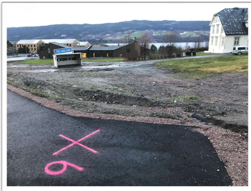
Figur 27 Bakkekontrollpunkt i form av asfaltspiker merket med et kryss med tydelig kontrast. Foto Kjersti Høyvik 2020
