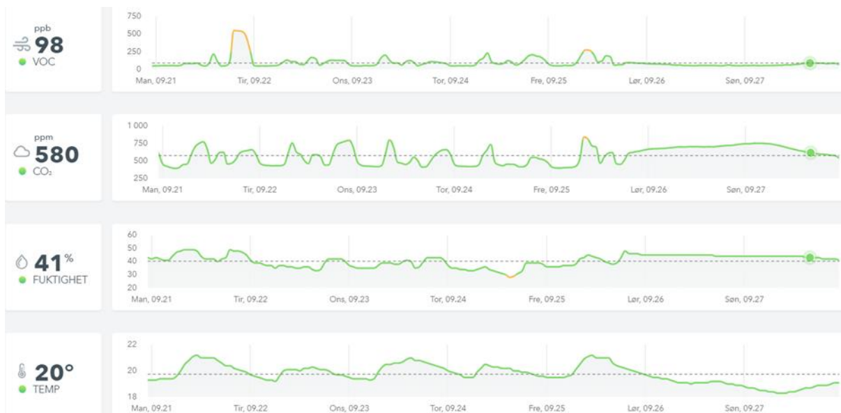
Måleresultat garderobe med gulvbelegg 21.september-27.september
