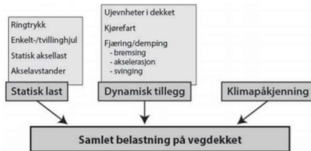
Figur 10: Faktorer som innvirker på den samlede lastpåvirkninger på vegdekket fra et kjøretøy (Aurstad J. , 2016).
