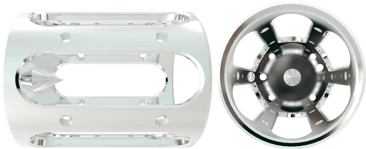
Figur 62: Topologioptimalisert sylinder (eget bilde)
