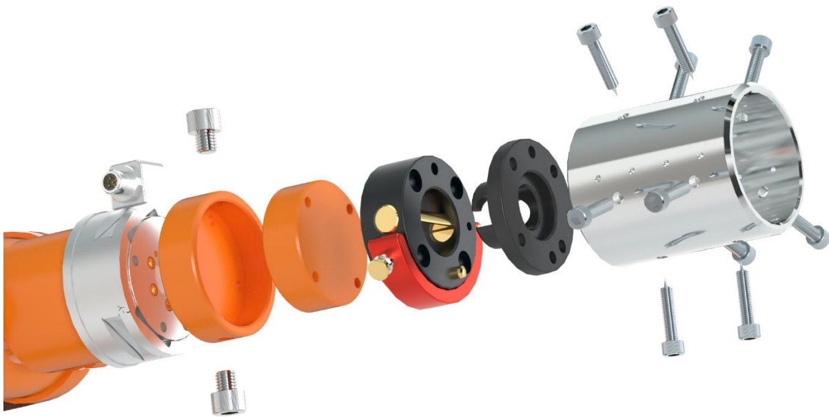
Figur 48: Bilde av robotfestet til testjiggen: Eksplodert (eget bilde)
