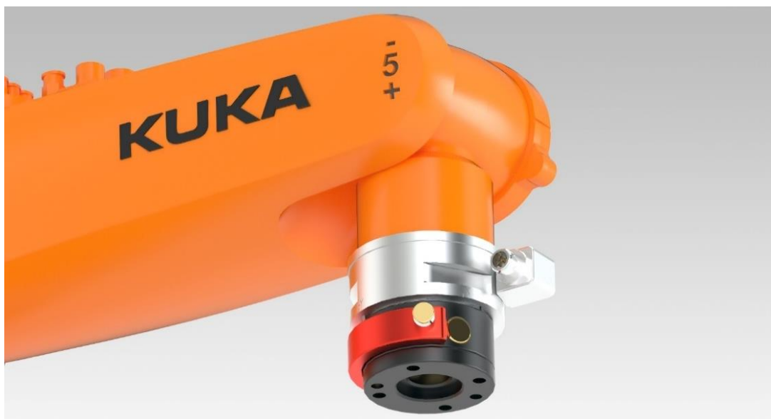
Figur 43: Montering av MGW063 (eget bilde)
