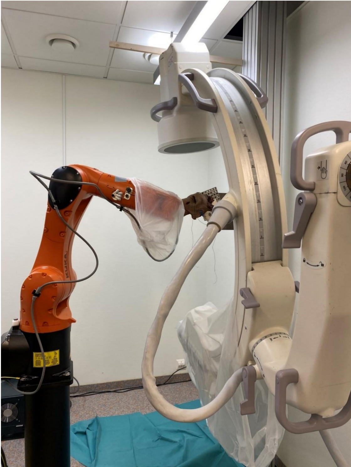
Figur 1: Nåværende testoppsett for skulder ved Ålesund Biomekanisk lab (eget bilde)
