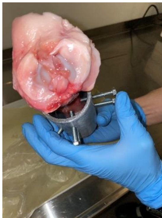
Figur 41: Test av nålespissbolter i prototype produsert i aluminium (eget bilde)
