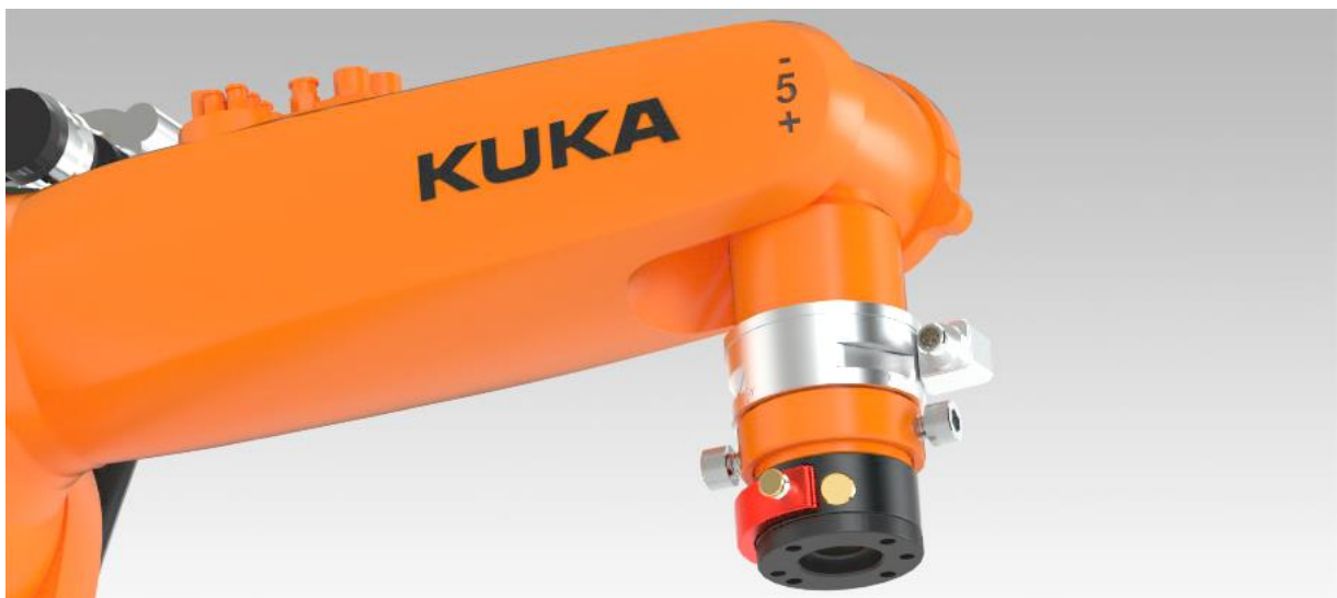
Figur 45: Montering av MGW063 med rotasjonskobling (eget bilde)
