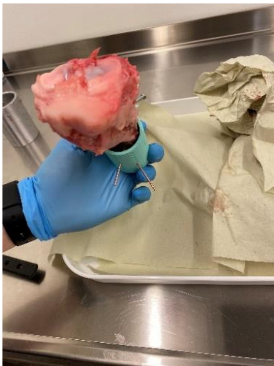
Figur 40: Test med kirurgiske låsepinner i 3D-printet prototype (eget bilde)
