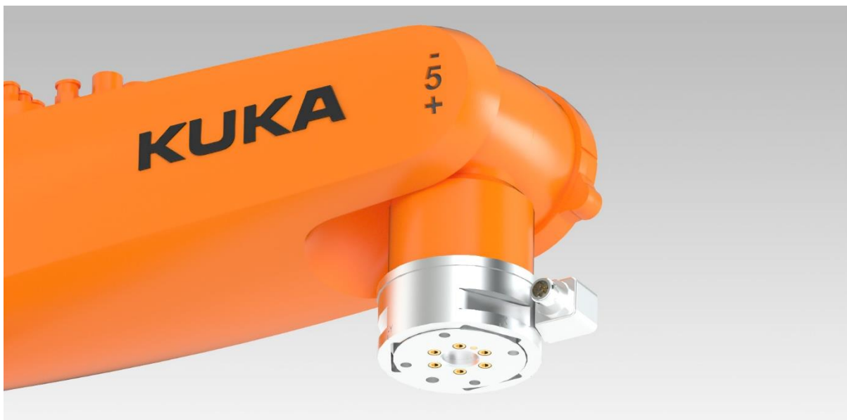
Figur 17: Montering av ATI Gamma (eget bilde)
