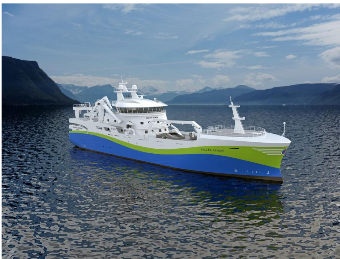
Figur 12: Konsept på LNG Ringnot fartøy med Plug in Hybrid fra Selvig Senior AS (Svendsen, 2020)
