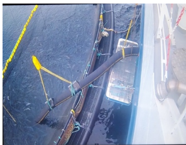
Figur 16: Tilsynskamera for lasteoperasjon. Foto: Privat.
