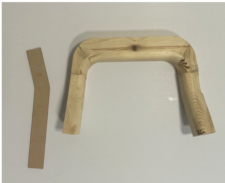
Test av rygg med kurven innarbeidet i formen. Malen til venstre viser kurvaturen i profil.
