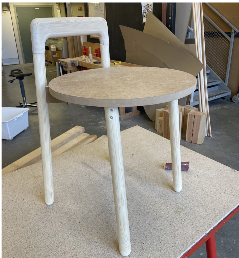
Bildet viser den første skissemodellen i 1:1. Her er diameteren på setet nærmere 40cm.
