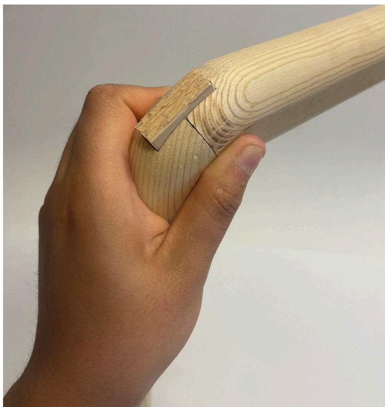
Detajebilde av hvordan klossen passer inn i sporene freset ut av bakbena og ryggen.
