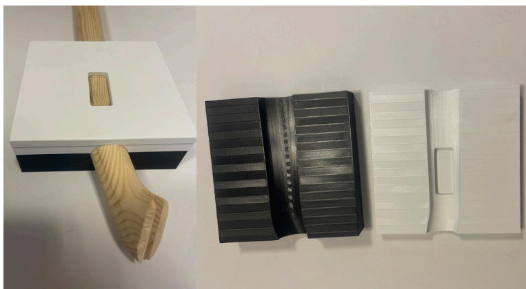
3D-printet hjelpejigg for å frese utsparing.
