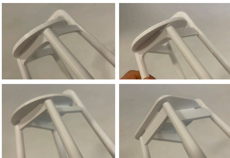
Bildene viser de to iterasjoner av henholdsvis firkantet understell øverst og K-staget nederst
