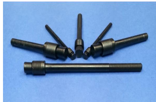
Figur 40: Viser oss nagleplugger, hvor 25% av materiale går i svinn. (Krieger, 2020)
