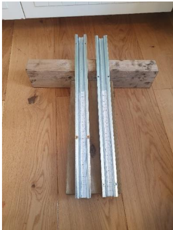
Figur 28: Oljerigg med markeringer ned rennen i mm
