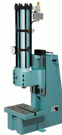
Figur 36: Viser et bilde av en hydropneumatisk presse. (Direct Industry, 2021)
