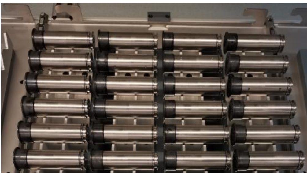
Figur 25: Dempesystemene på brett etter Produksjonstrinn 1
