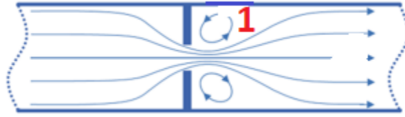
Figur 3: Viser oss fenomenet «saksing». Ved skarpe innsnevringer kan det oppstå (1) turbulent strømning. (Pedersen, 2020)
