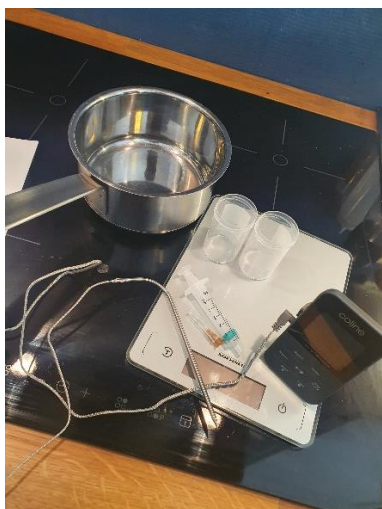
Figur 30: Utstyr som ble brukt for å forandre oljens flyteegenskaper
