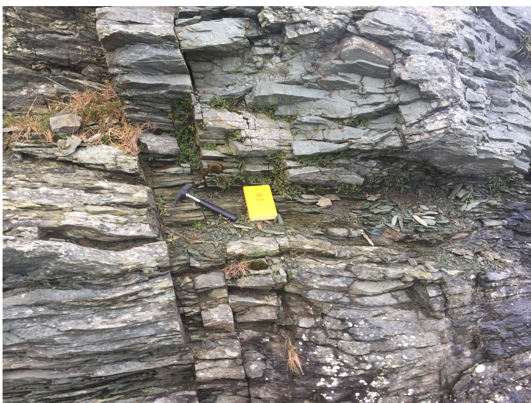
Figur 4.3: Lokalitet 2, grønskifer. Viser tydelig skifrighet og flere sprekkesett. Stedvis oppknust/overflateforvitret, vises godt til høyre i nederste bilde. Bildene er tatt mot vest-nordvest.
