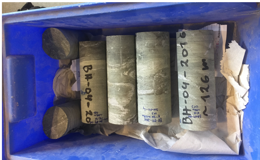
Figur 5.1: Fire kjerneprøver fra BH-04-2016 før testing.
