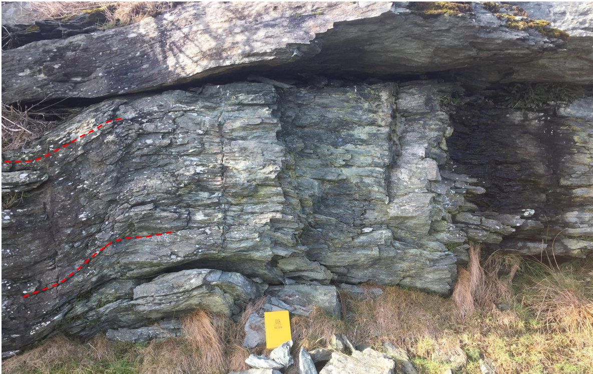
Figur 4.2: Lokalitet 1, grønnskifer. Tydelig skifrig foliasjon med tilnærmet retning nord. Det vertikale sprekkesettet kan også observeres. Foldestrukturer markert med rød striplet linje. Bildet er tatt mot vest.
