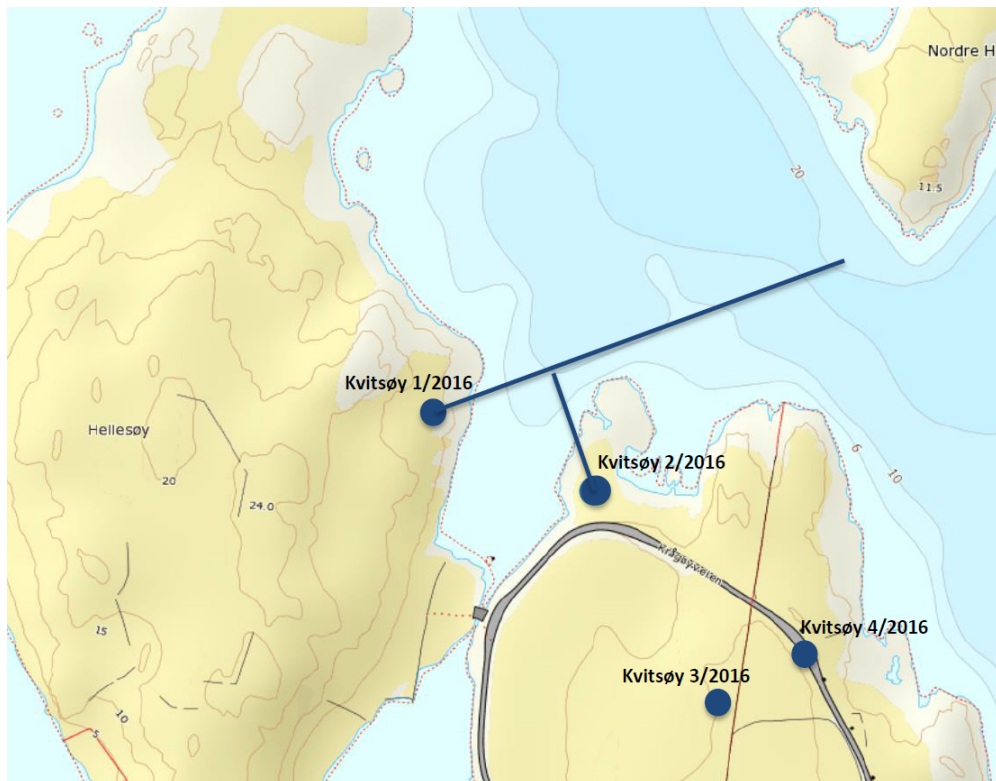
Figur 4.19: Oversikt over borehullene på Kvitsøy. Borehull 1 er boret med et fall på ca. 45^\circ og borehull 2 med et fall på ca. 74^\circ . Retningen på borehullene er indikert med blå streker. Borehull 3 og 4 er boret vertikalt. Hentet fra Slobodinski (2016).
