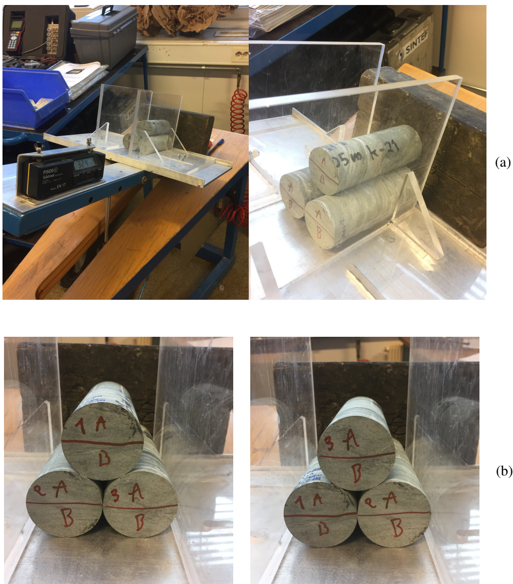
Figur 5.3: (a) Oppsett av Stimpson-metoden på tilt-test apparatet. (b) To forskjellige kjerneprøveoppsett med varierende overflatekontakt.
