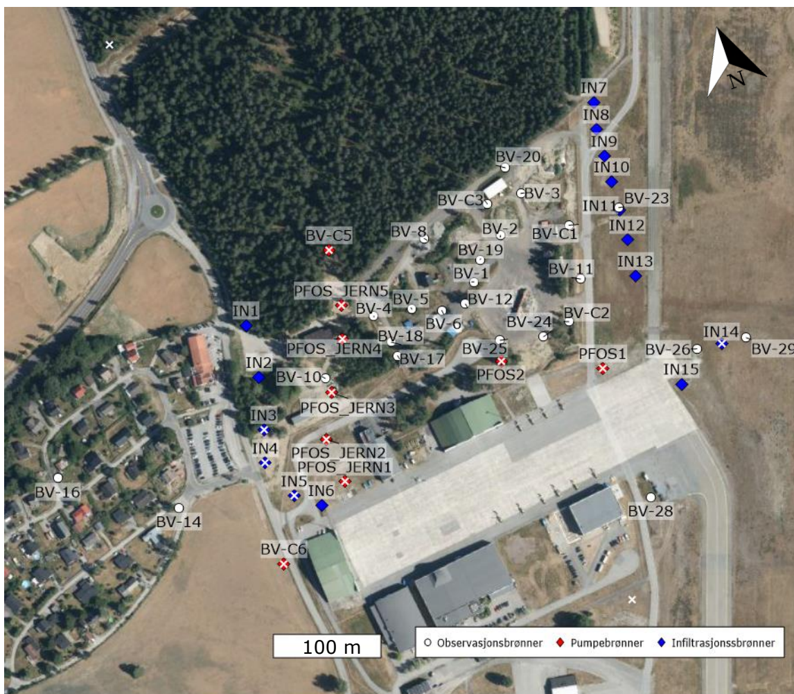
Figur 4.2: Oversikt over peilede brønner på BØF og området rundt. Pumpe- og infiltrasjonsbrønner med registrerte vannivåmålinger er markert med hvite kryss
