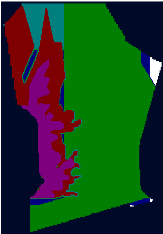
Figur 3.11: Hydrauliske konduktivitetssoner i lag 2, overgangen til et delta bunnlag. K-verdien er lavere enn i lag 1 på grunn av finere masser nedover i dypet. Sone 5 (mørkerød) ble tildelt lavere K enn sone 6 (lilla) helt vest i ravinen. Dette var nødvendig for å gjenskepe den bratte hydrauliske gradienten for området
