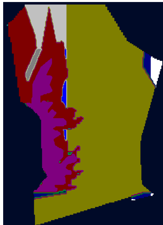
Figur 3.10: Hydrauliske konduktivitetssoner i lag 3, siltig delta bunnlag. Laget består av finere masser av silt/leire, derav lavere K-verdier enn lag 1 og 2. Ravineområdet mot vest er likt som i lag 2.
