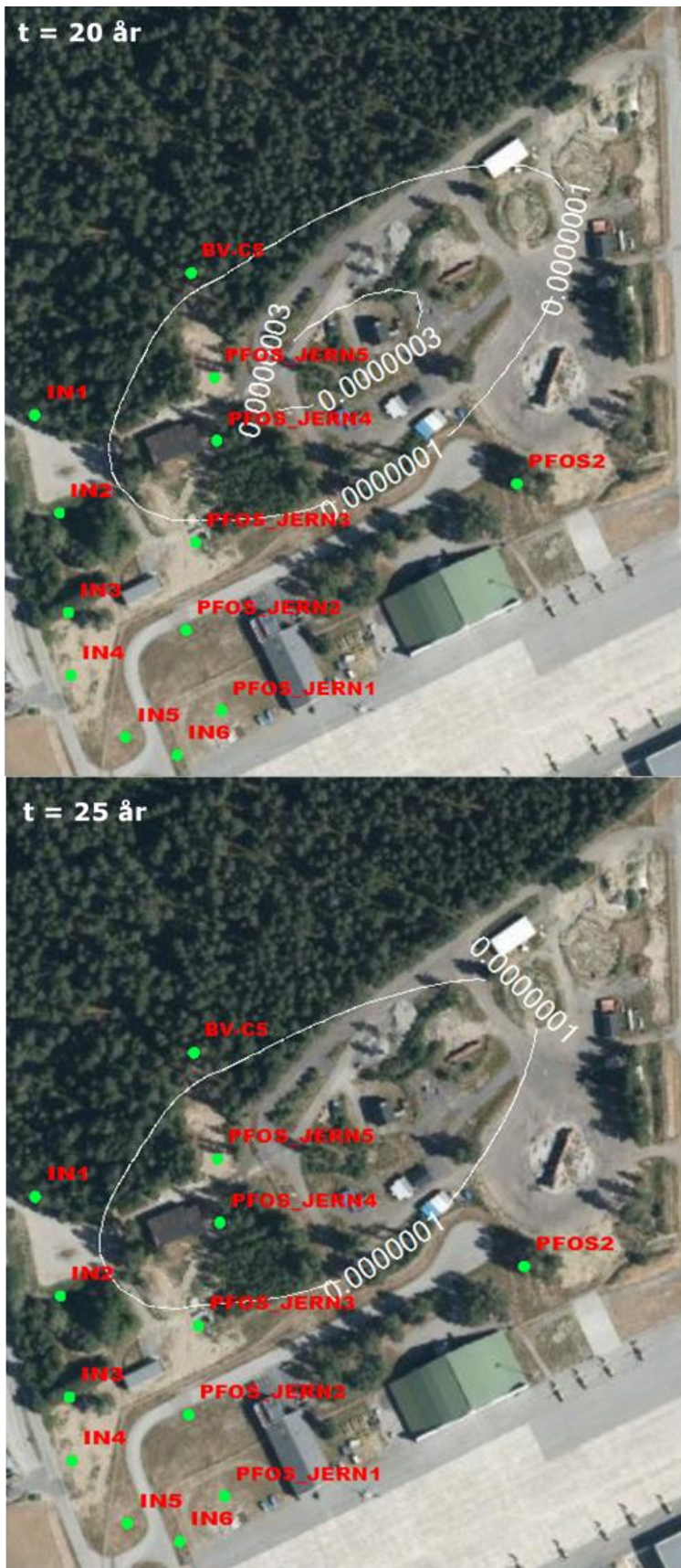
Figur 5.13 Simulering av reaktiv PFOS-transport ved MT3DMS. Den øverste figuren viser 20 års simuleringstid og den nederste figuren 25 års simuleringstid. Pumpe- og infiltrasjonsbrønnene er oppgitt med grønne punkter. Det er definert 2 konturer med PFOS-konsentrasjoner på 100 og 300 ng/l. PFOS-konsentrasjonene er oppgitt i g/l.
