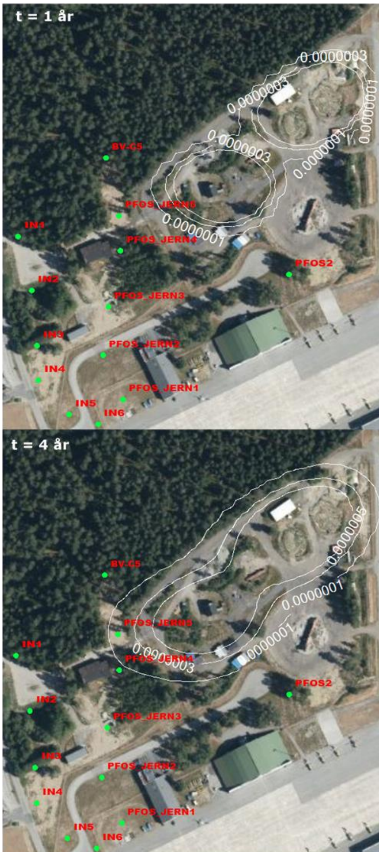
Figur 5.11: Simulering av reaktiv PFOS-transport ved MT3DMS. Den øverste figuren viser 1 års simuleringstid og den nederste figuren 4 års simuleringstid. Pumpe- og infiltrasjonsbrønnene er oppgitt med grønne punkter. Det er definert 3 konturer med PFOS-konsentrasjoner på 100, 300 og 500 ng/l. PFOS-konsentrasjonene er oppgitt i g/l.
