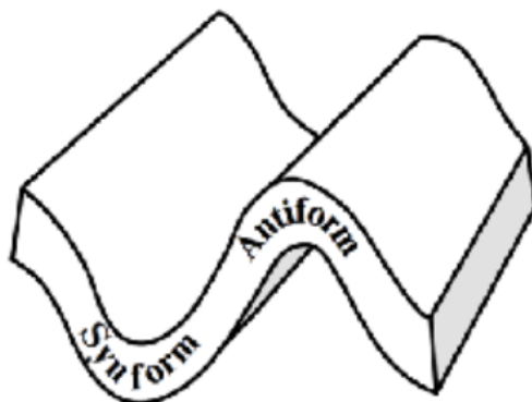
Figur A.7: En forenklet illustrasjon av antiform og synform. Figuren er hentet fra (Rowland mfl., 2007) og modifisert i Adobe Illustrator.
