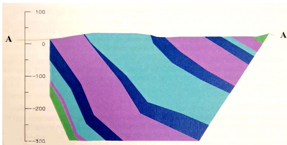
Figur 3.12: Et vertikalt snitt A-A' fra Figur 3.6 ved Akselberg. Grønne lagene tilsvarer gneis og resterende lagene; lyse blå, mørke blå og lilla tilsvarer kalkstein. Figuren er hentet fra Watne, 2001.
