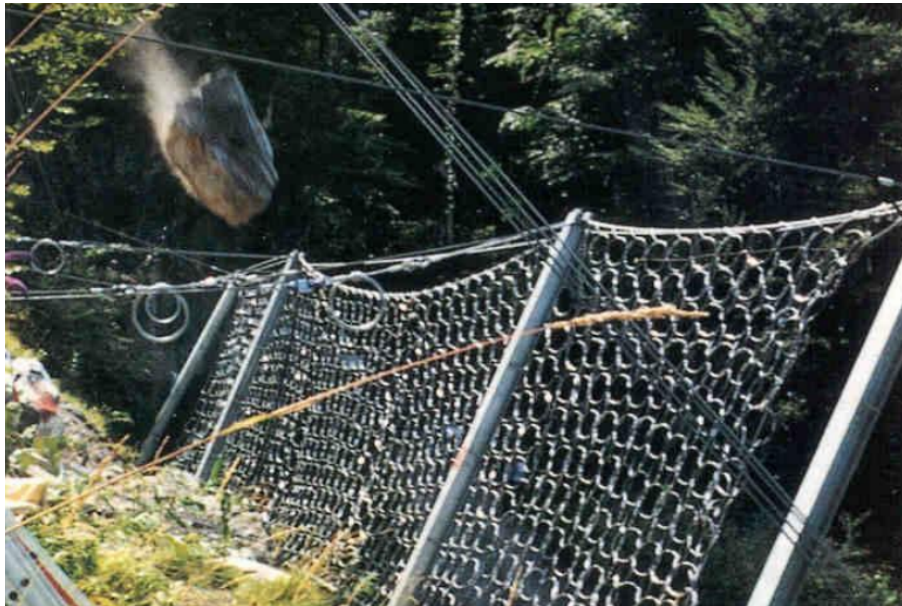
Figur 2.36: Fanggjerde rett før anslag av et steinsprang . Bildet er hentet fra Bjordal et al. (2011).
