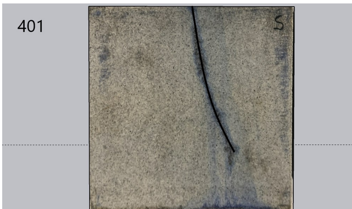
Figur G.22: Bergartsprøve 004 sett sørfra etter splitting av sprekk 401. Sprekk er markert i svart. Bilde er tatt 29.04.2020 og redigert i SketchUp pro.
