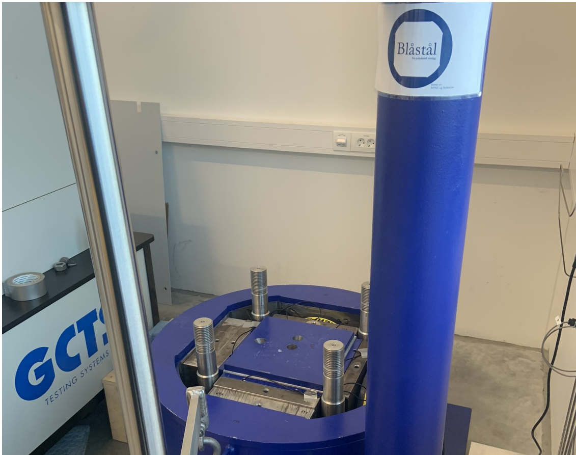
Figur 5.6: Testtrigg med alle stålplater på prøvestykke. Løkk er enda ikke satt på.
