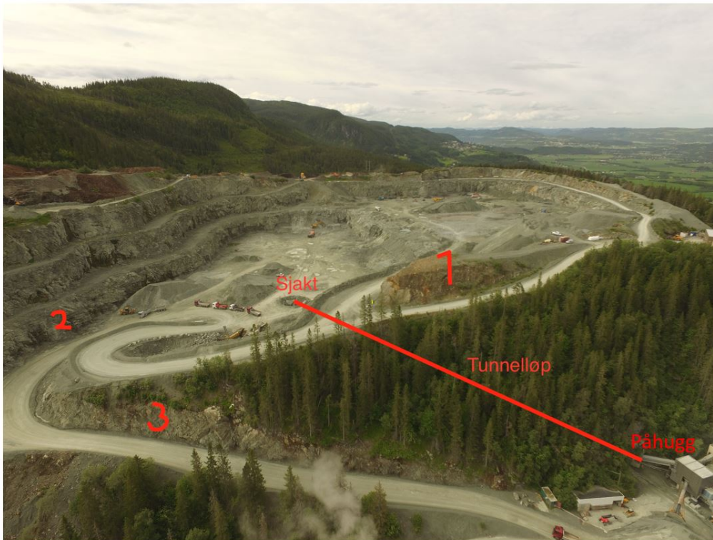
Figur 2.4: Oversikt over dagbruddet i Vassfjell Pukkverk med markering av tunnel, sjakt og tre lokasjoner for feltarbeid (Foto: Franzefoss Pukk AS, modifisert av Hansen (2019)).
