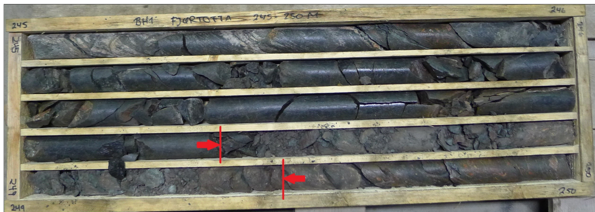
Figur 8.8: Borkjerner 245-250 m fra styrt kjerneborhull fra Fjørtofta sør. Start og slutt på svakhetssonens kjerne er markert. Modifisert etter Norconsult (2012).
