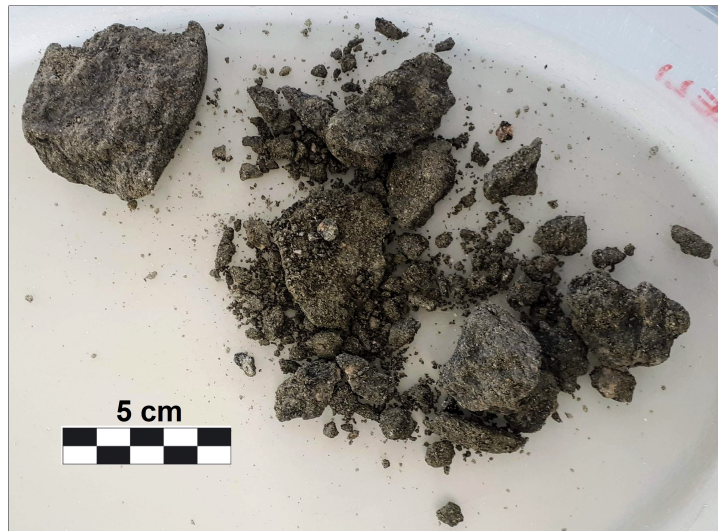
Figur 6.8: Kjernematerialet til prøve 3 fra pel nr. 23698 (Birkeli, 2020).
