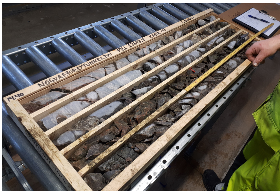
Figur 8.5: Kjernelogging av pel nr. 23658-23662, som jeg fikk delta på ved befaring til Nordøyvegen. I denne kassen er bergarten vurdert til å være laminert metaarkose. De tre øverste kjernemetrene har SRF = 2,5, mens de to nederste kjernemetrene har SRF = 5 (Birkeli, 2020).
