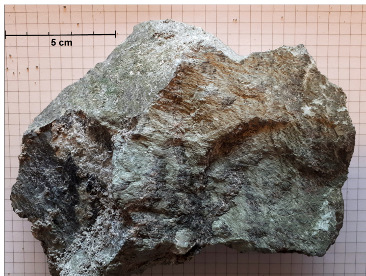
Figur 8.16: Steinprøve fra pel nr. 32192 i parti 7 (Birkeli, 2020). Nede til venstre er det noe sprøytebetong på prøven. Ellers er mye av den dekket med et tynt grønt og glatt belegg der mineralkornene har prismatisk form.
