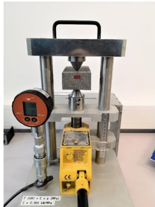
Figur 6.13: Punktlasttest i retning A-C på rektangulær basalt-blokk med Enerpac-jekk.
