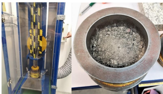
Figur 6.16: Maskinoppsett for testing av S_{20} og resultat av prøvemateriale etter 20 slag med 14 kg lodd.
