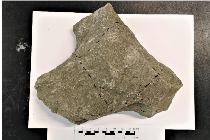
Figur 6.10: Basalt-blokken som ble brakt med fra pel 1350 i Leirvikartunnelen. Sorte stiplede linjer viser hvor blokken ble kappet. Blokken veide ca. 10 kg og framsto som middels porøs.
