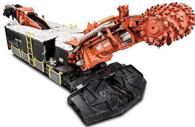
Figur 4.6: Elektrisk roadheader av typen MH621 med integrert lastebånd, for berguttak i bergrom med UCS opptil 120 MPa (Sandvik, 2020b).
