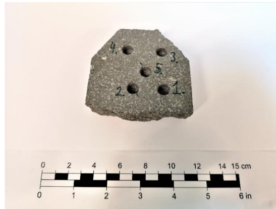
Figur 6.17: Inntrengning på basalt-prøve etter fem tester med 8,5 mm bor av wolframkarbid. Største inntrengning ble målt til ca. 9,1 mm og minste på 7,7 mm.
