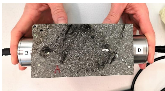
Figur 6.12: Oppsett for testing av lyd hastighet på basalt-kuben. Lyd hastigheten blir her testet i retning B-D med avstand 133,1mm.
