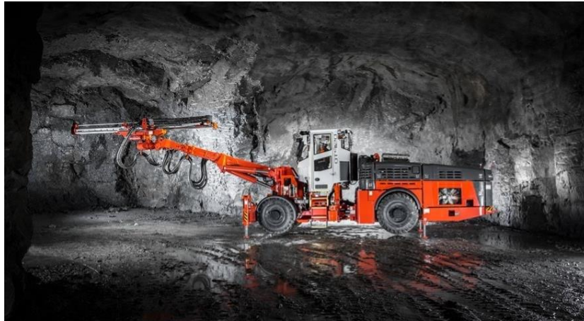
Figur 4.1: Eksempel på borerigg av typen DT912D, med én bom, som har blitt brukt til strossing av Forsattunnelen i Nordland, fra T7,5 til T8,5 profil (Nessestrand, 2020) (Røberg, 2020).
