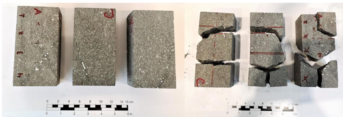
Figur 6.15: Kappede rektangulære basalt-prøver for testing av punktlastindeks og bruddutvikling i prøvene etter kraftpåføring med Enerpac-jekken.
