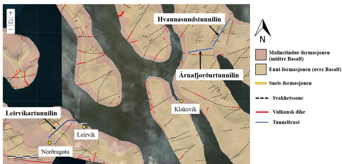
Figur 6.2: Oversiktskart over aktuelt område med omtalte vegtunneler. Kartet viser fordeling av de ulike basalt-rekkene og lokaliserte svakhetssoner og diker (Jarðfeingi, 2020).
