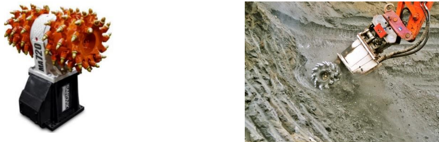
Figur 4.8: Eksempel på monterbart kutterhode med transversal rotasjon (Sandvik, 2020b).
