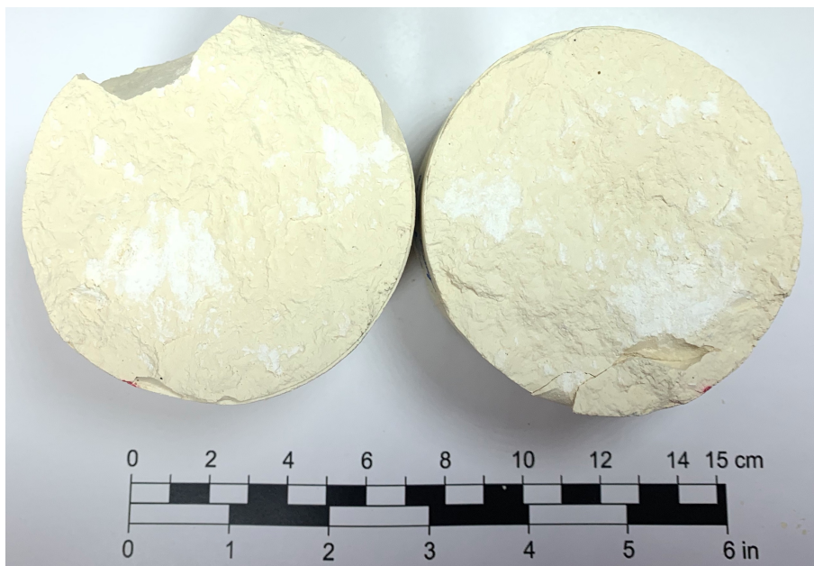
Figur 55: GNM-prøve nr.2 etter skjærttest.
