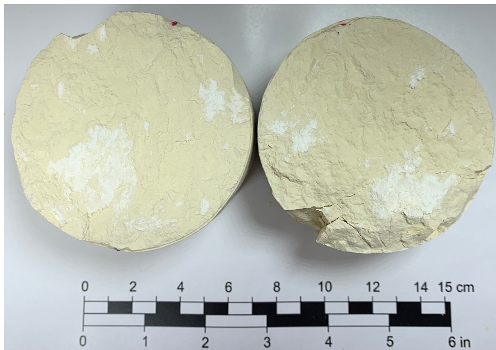
Figur 38: GNM-prøve etter fullført skjærttest. Skjærretningen til venstre sprekkeflate var i retning «nord» i bildet, og skjærretningen for høyre sprekkeflate var retning «sør» i bildet.
