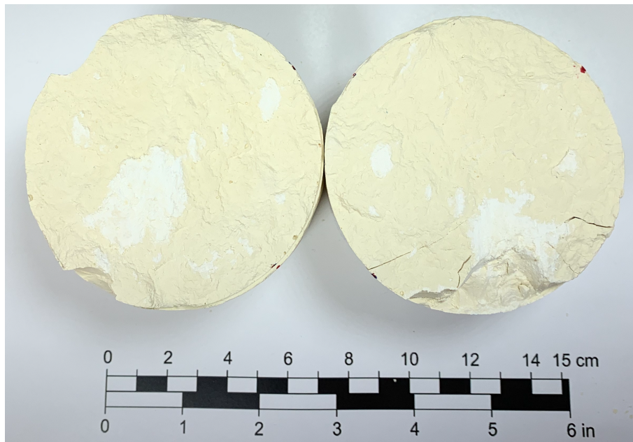
Figur 58: GN-prøve nr.5 etter skjærttest.
