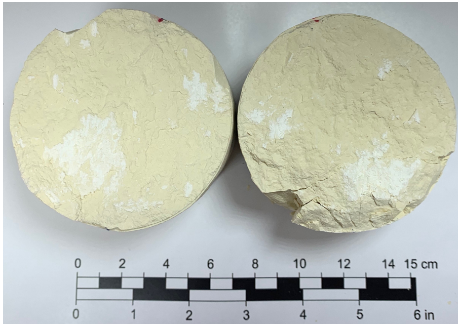
Figur 54: GNM-prøve nr.1 etter skjærttest.
