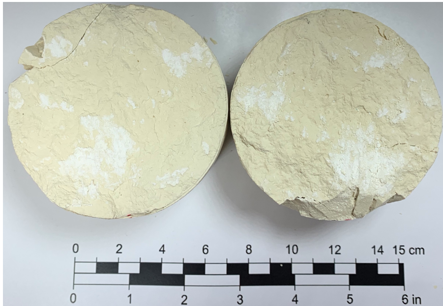
Figur 56: GNM-prøve nr.3 etter skjærttest.
