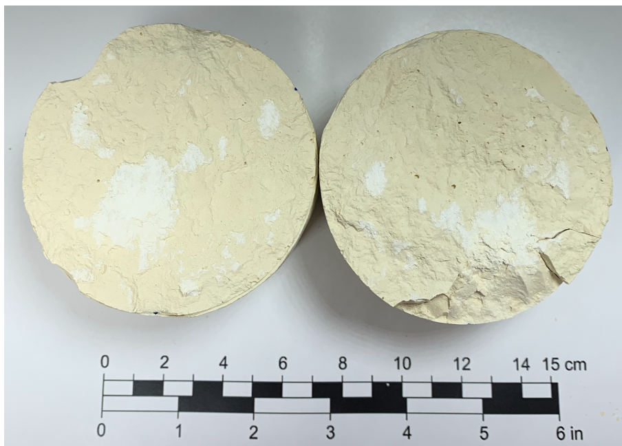
Figur 57: GN-prøve nr.4 etter skjærttest.
