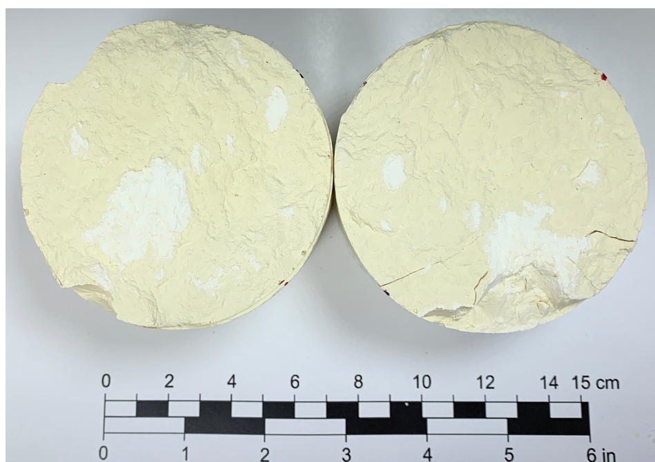
Figur 39: GN-prøve etter fullført skjærttest. Skjærretningen til venstre sprekkeflate var i retning «nord» i bildet, og skjærretningen for høyre sprekkeflate var retning «sør» i bildet.
