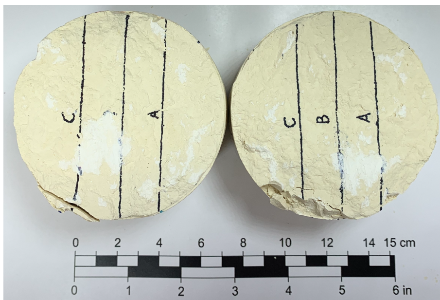
Figur 59: GN-prøve nr.6 etter skjærttest.
