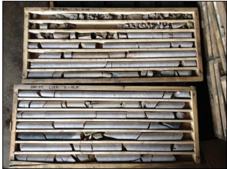
Figur 7.29: Kjerneborhull KB-1, seksjon 0-14 m fra prosjektet rv. Dagslett - Linnes (NGI, 2016).
