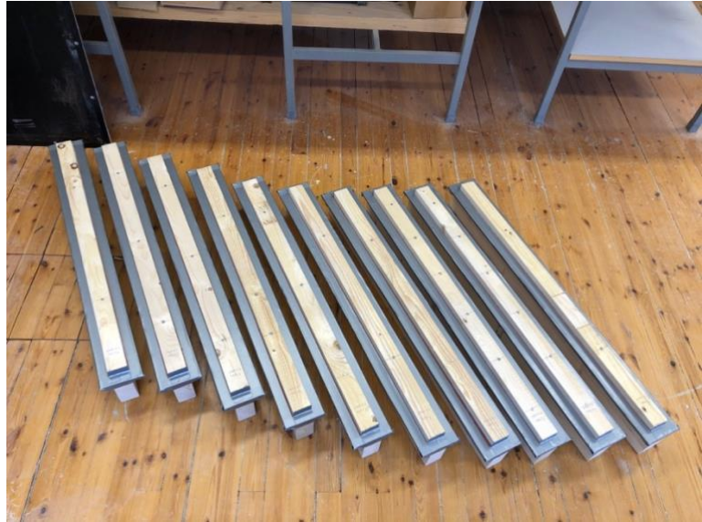
Figur 24: Ferdige prøver med teip rundt kantene
