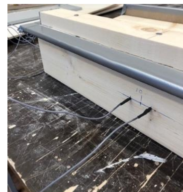
Figur 33: Elektroder med loddede ledninger
