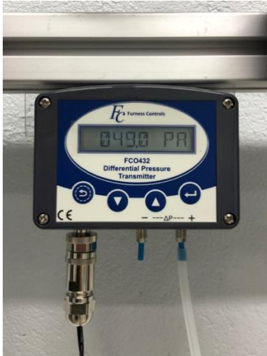
Figur 29: Mikromanometer som måler differensialtrykk
