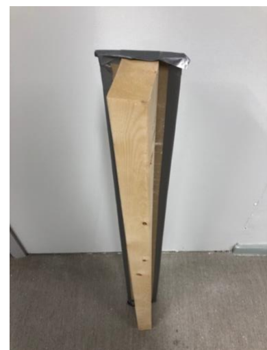
Figur 57: Vindskjevhet i stender
