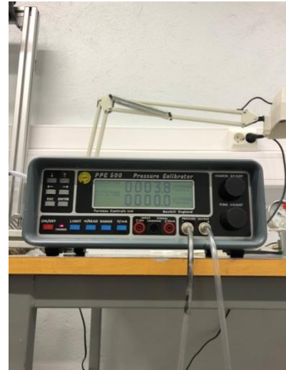
Figur 31: Mikromanometer som måler lufttrykk
