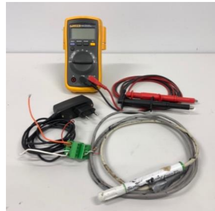
Figur 36: Sensor og måleutstyr for relativ fuktighet
