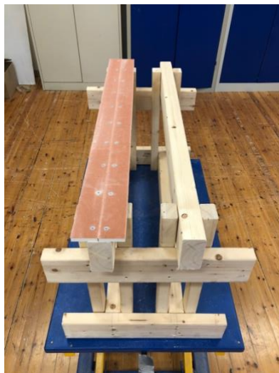
Figur 21: Montering av vindsperre
