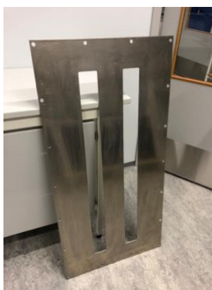
Figur 26: Lokk med åpninger for prøver
