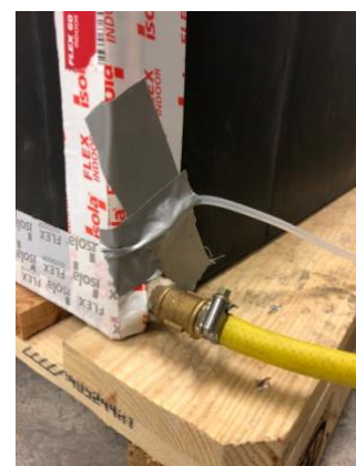
Figur 27: Tilkobling for lufttilførsel og mikromanometer
