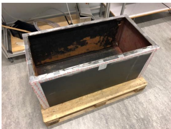
Figur 25: Boksen som benyttes til luftlekkasjemålinger og oppfukning
