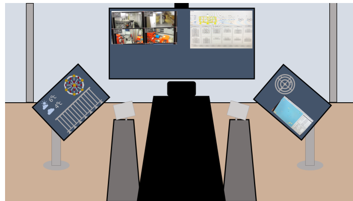
Figur 5.3.9: Arbeidsstasjonen består av to høyt teknologiske stoler, to sideskjermer og en hovedskjerm til hver stol. Sideskjermene inneholder standardisert informasjon og data om systemet. Venstre sideskjerm er benyttet for fremvisning av miljødata, mens høyre side viser navigasjonsdata. Alle operasjoner gjennomføres fra hovedskjermen.
