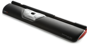
Figur 5.3.4: Den rullende stangen foran på flaten har en dynamisk del som kan beveges til høyre og venstre for å flytte musepekeren på skjermen. Bildet er hentet fra Design (2001).
