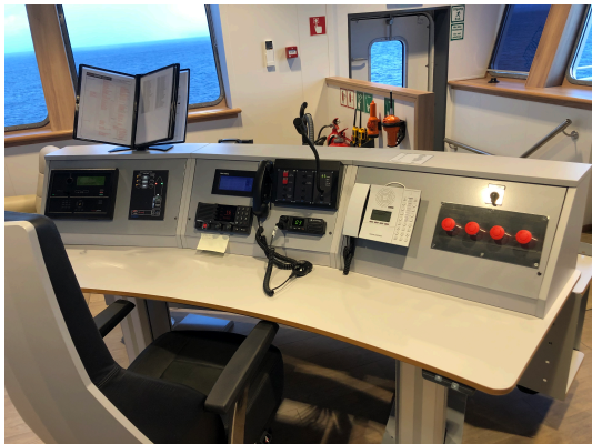
(c) Pult1: Kommunikasjon og alarmsentral
