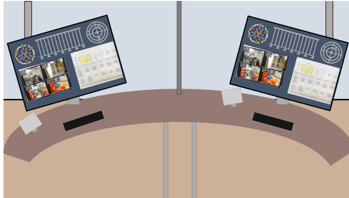
Figur 5.3.11: Kontrollrommet består av fire stasjoner. Der hver stasjon har funksjonalitet etter hvilke operasjoner som kan utføres. Designet er en åpen løsning, slik at det skal være lett å kommunisere verbalt mellom stasjonene.
