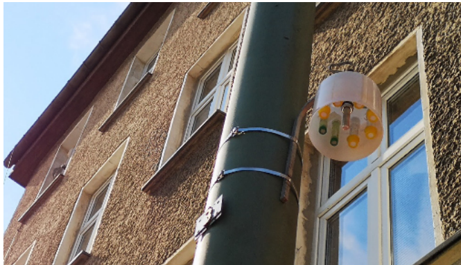
Figure 3.9: Passive sampler near Brückenstraße in Berlin to measure NO 2 levels. Image courtesy: Paul Herenz, Senatsverwaltung für Umwelt, Verkehr und Klimaschutz Berlin [41]
