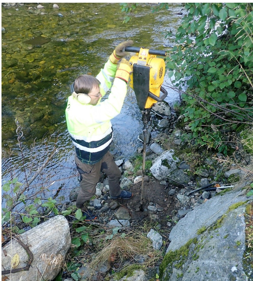
Figur 4.5: Sonderboring ved lokalitet for Pb4 ved østbredden av Haugaelva, 25. sept. 2019.
