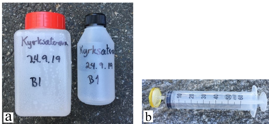
Figur 4.11: Utstyr til vannprøvetaking. a) Prøveflasker – 500 ml og 100 ml. b) 50 ml sprøyte med 45 µm filter.
