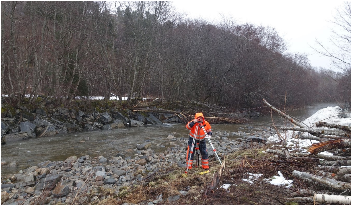
Figur 4.6: Nivellering i brønnområdet med Sokkia nivelleringskikkert, 12. mars 2020.
