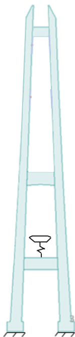
Figur 18: Kobling av brubjelke til planumsrigel
