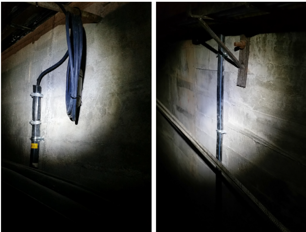
Figur 3.5: Venstre: Avslutning av SAAF-kabelen like under damkrona. Høgre: Kabel festa til kvelvet med klemmar. Foto: Cautus Geo AS.
