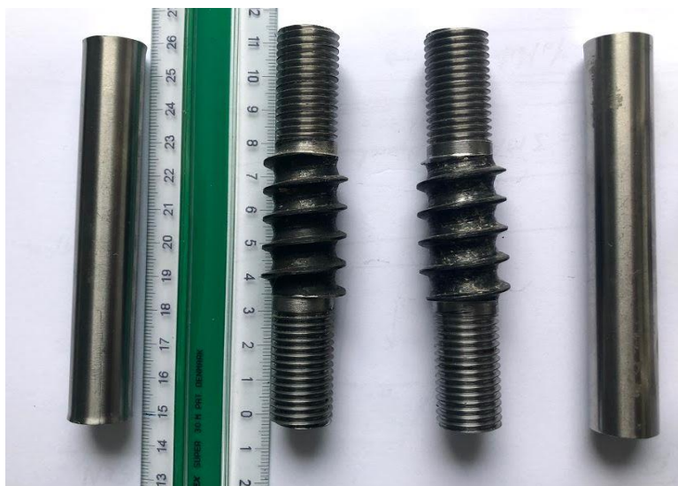
Figur 7 : Dyble og gjengestenger som ble brukt i forsøkene
