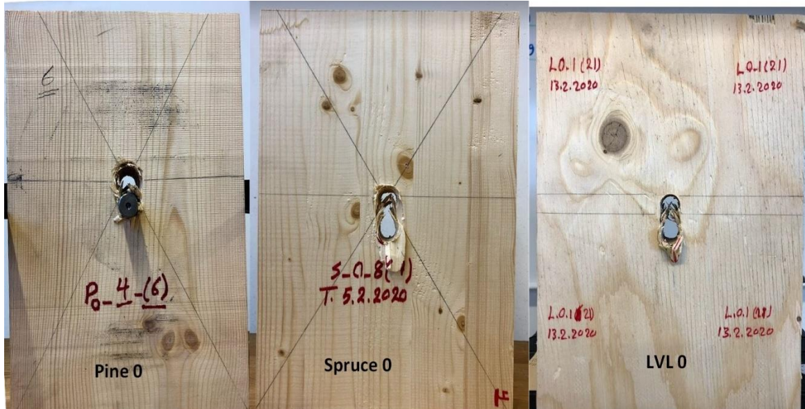
Figur 14: Den vanligste bruddformen på hullkant-tester i parallell med fiberretning.
