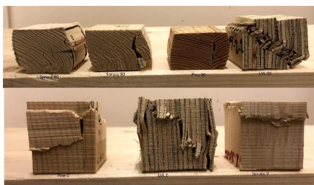
Figur 22: De mest vanlige bruddformene som oppstår under trykkfasthetstesten.
