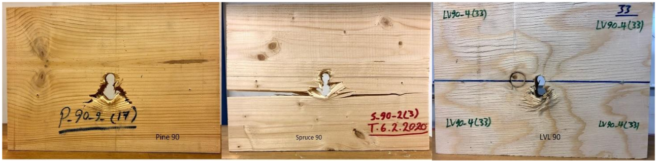
Figur 15: De mest observerte bruddformer i hullkant-tester vinkelrett på fiberretning.
