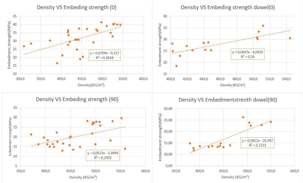
Figur 17: Plotting av hullkantfasthet mot tetthet med gjengestenger og dyble for parallell og vinkelrett på fiberretning.
