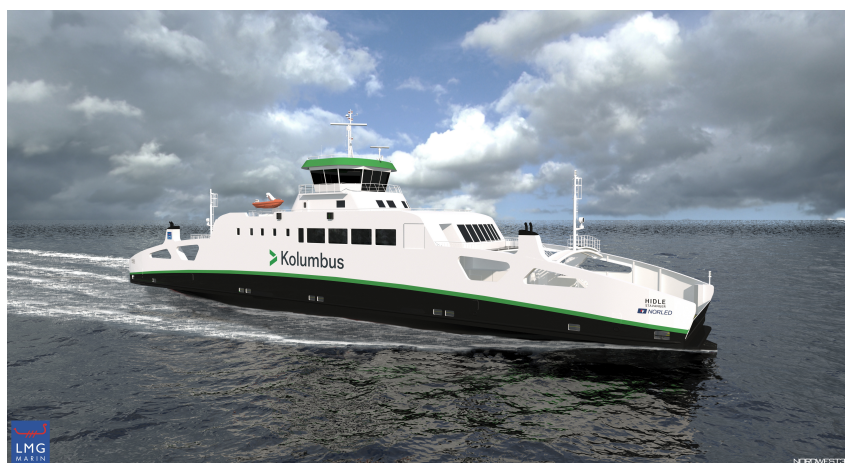
Figur 6.6: Den planlagte hydrogenfergen til Nordled som skal brukes i Finnøysambandet. Bildet krediteres Nordled. [143]
