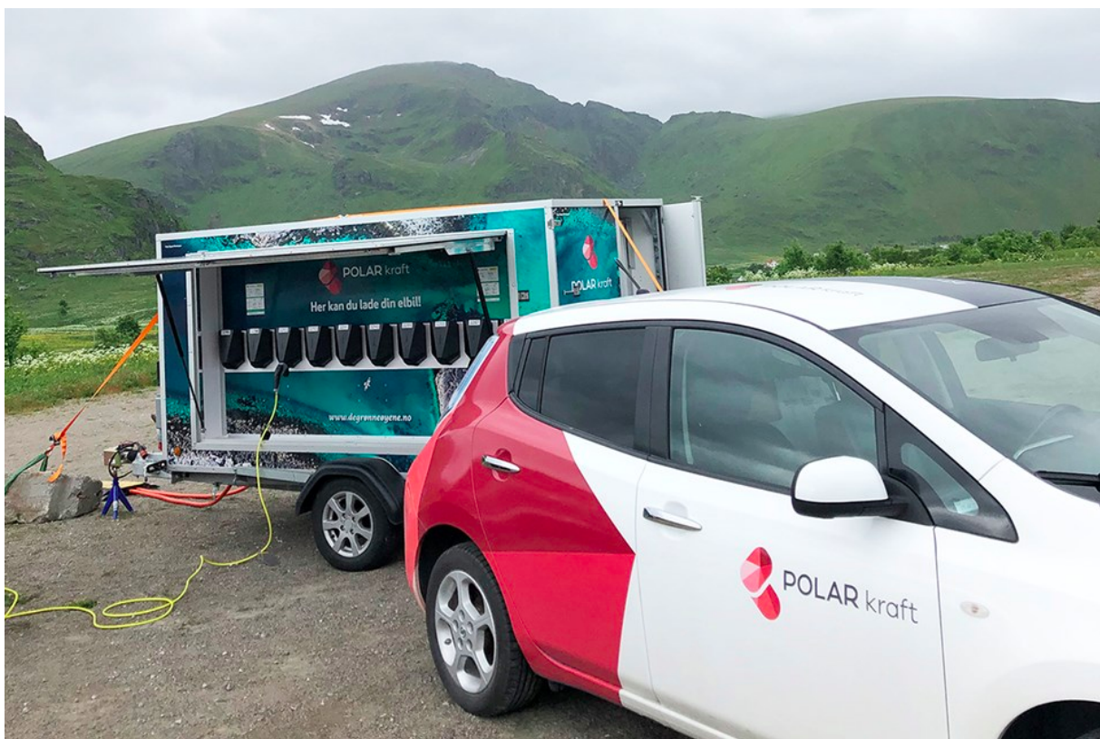
Figur 3.9: Mobil ladestasjon utplassert ved Fredvang, med ti uttak for lading. [105]
