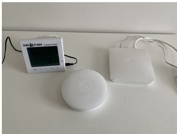
Figur 3.2: Instrumentene som er brukt i målingene: Elma DT-802D og Wave Plus med tilhørende Hub fra Airthings
