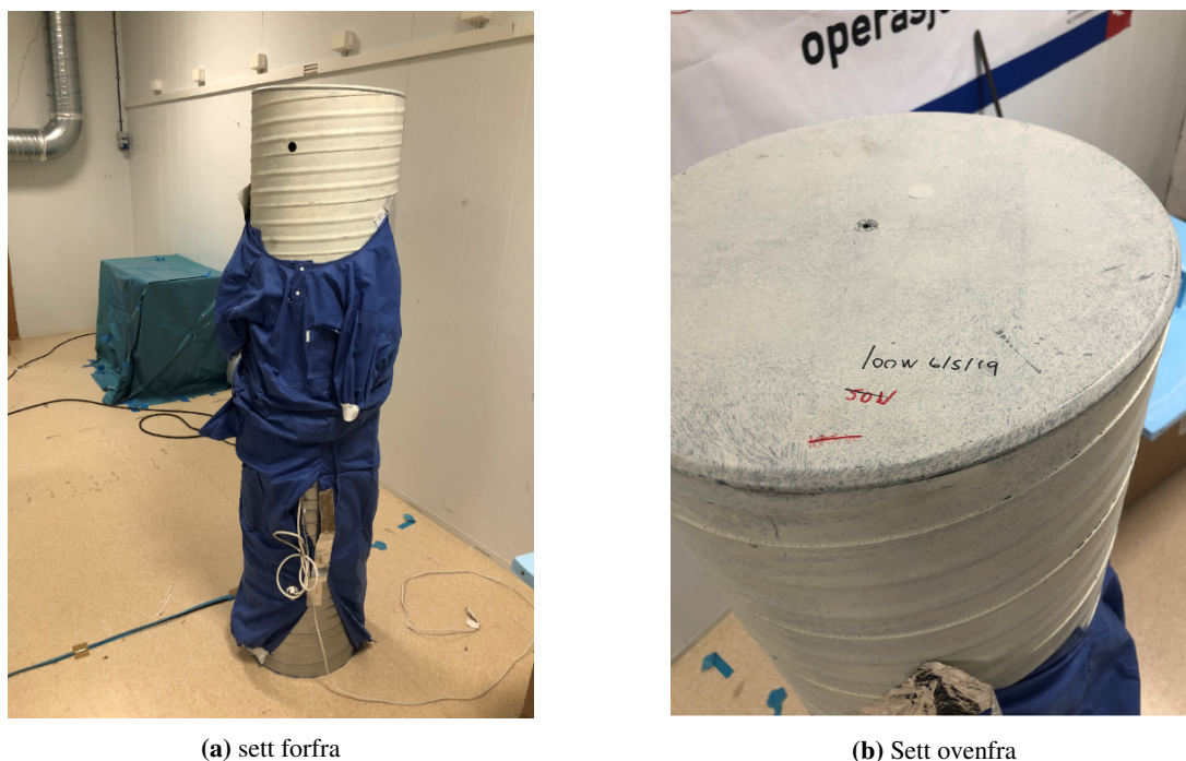
Figur 4.8: Sylinder med 100 W pære
